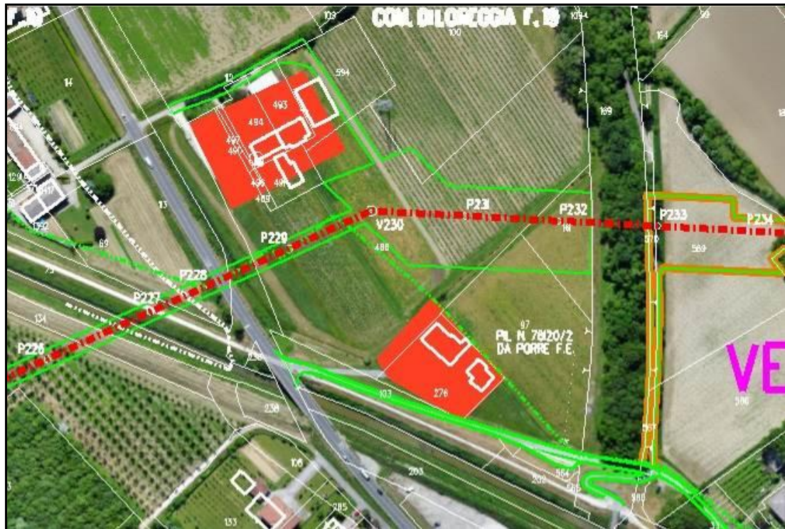
Fig. 8.2/a – Esempio di ricettori (abitato semi-concentrato retino arancione) per i quali prevedere barriere antirumore
