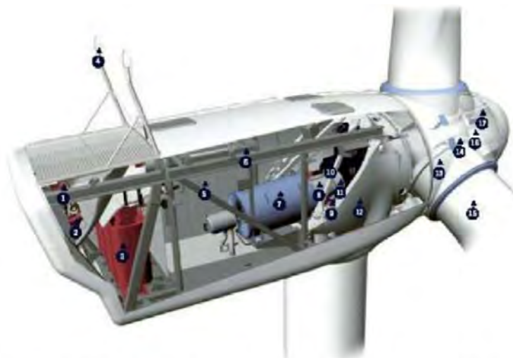
Fig. 4-1a. Schema di navicella completa di rotore e di pale (1. Raffreddamento olio; 2. Raffreddamento generatore; 3. Trasformatore; 4. Sensori condizioni vento; 5. Sistema controllo; 6. Argano e rotaia di movimentazione pezzi; 7. Punto di controllo generatore; 8. Collegamento generatore-moltiplicatore giri; 9. Azionamento imbardata; 10. Moltiplicatore; 11. Freno di stazionamento; 12. Cella di sostegno macchinario; 13. Cuscinetto di pala; 14/15. Albero; 16. Collegamento per azionamento pitch; 17. Controller dell'albero)
