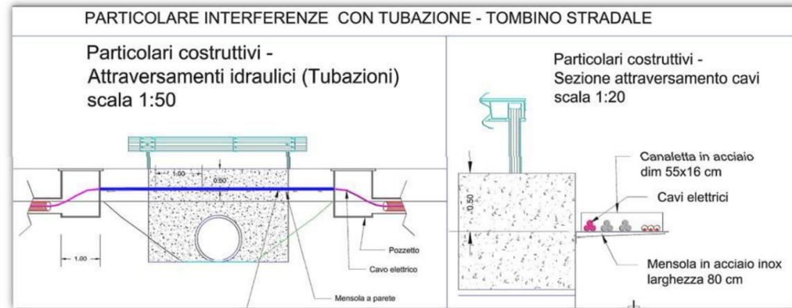
Oppure, laddove necessario, mediante scavo con tecnica TOC perforazione orizzontale teleguidata).
