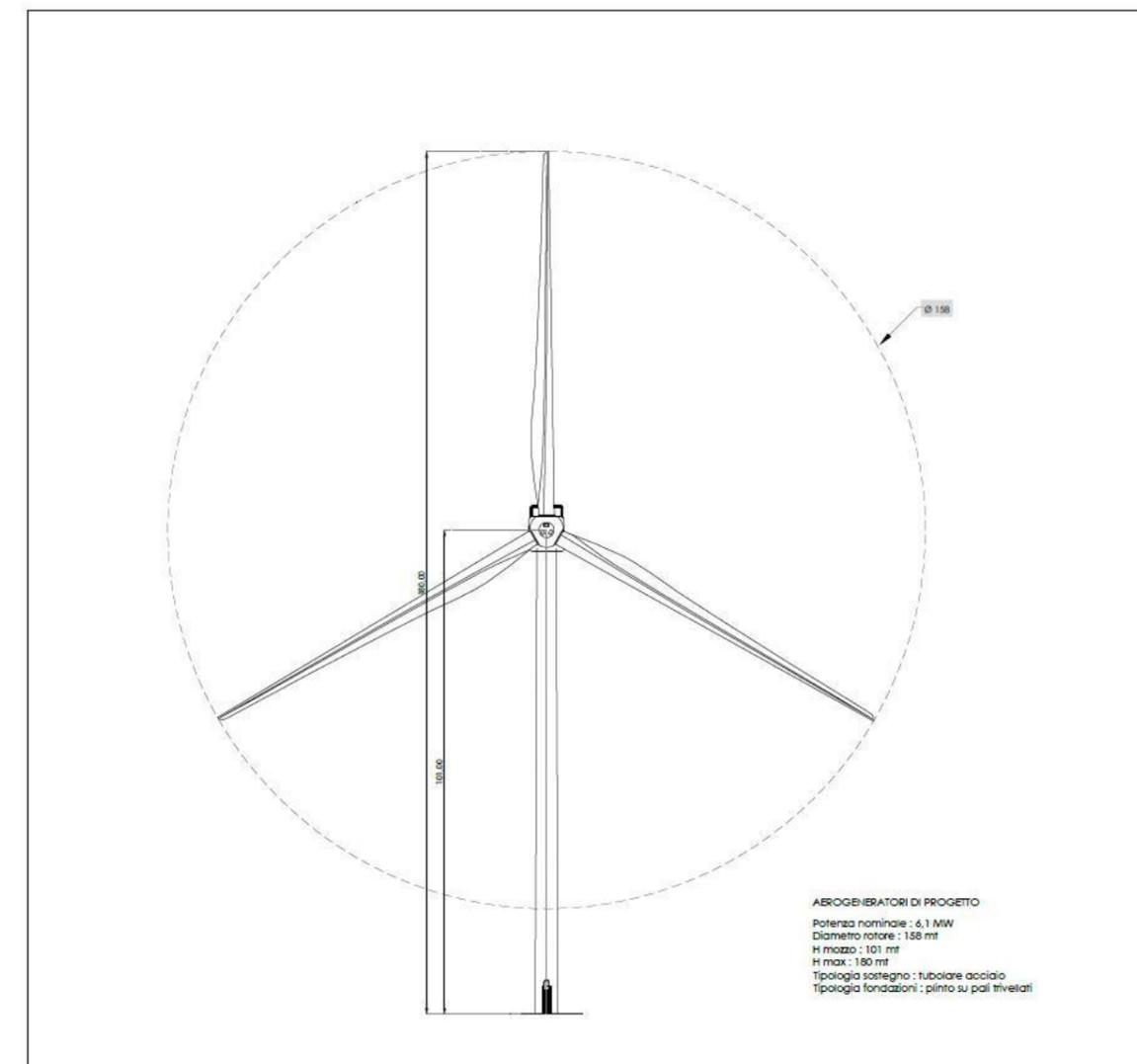
Caratteristiche geometriche aerogeneratori di progetto
