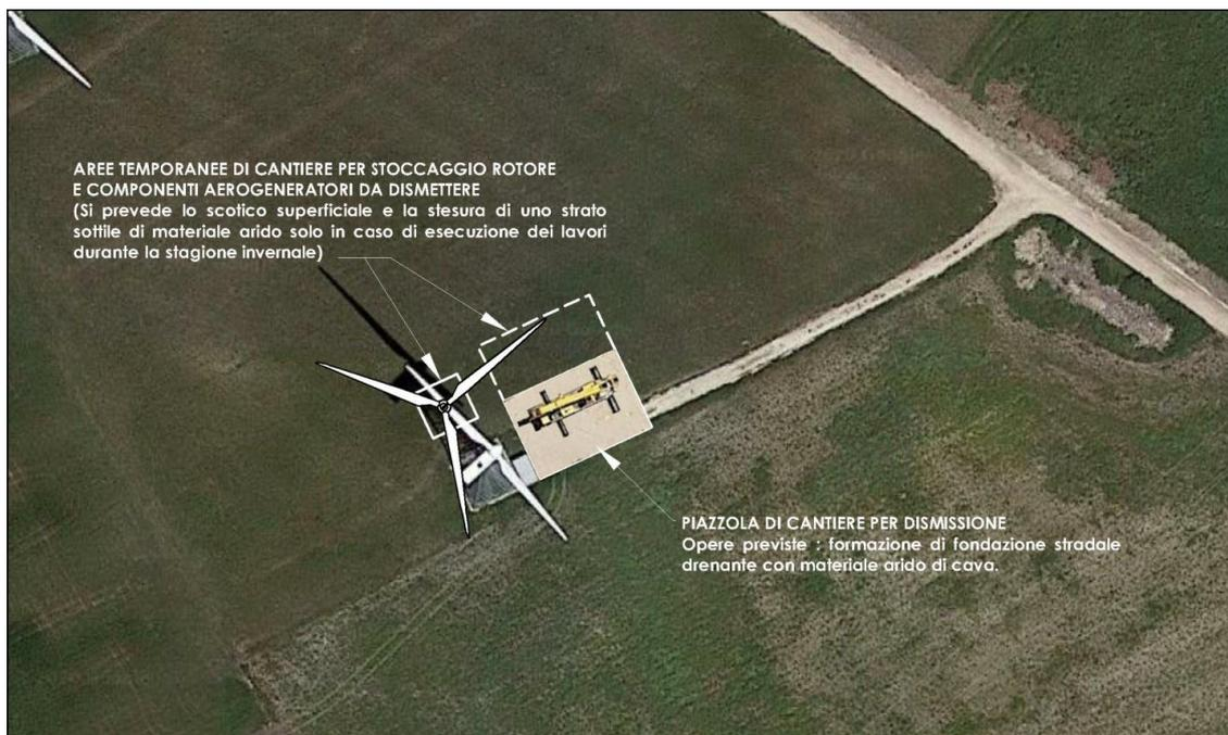
*Fase di dismissione : esempio planimetria opere di cantiere*
