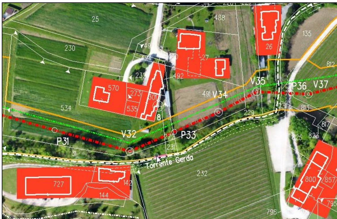
Fig. 8.2/a – Esempio di ricettori (abitato semi-concentrato retino arancione) forniti di barriere antirumore
