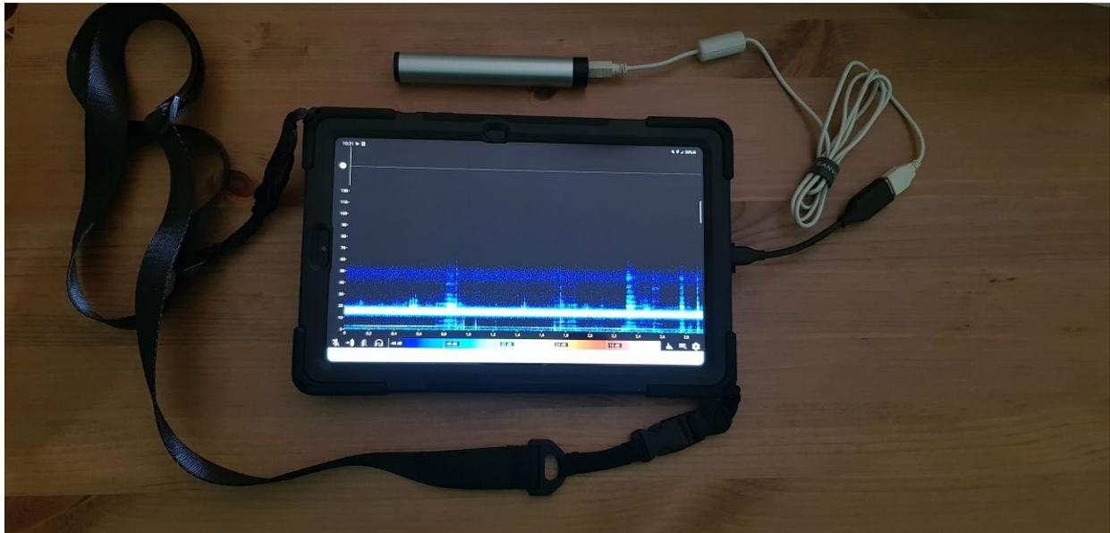
Figura 3.1: Strumentazione utilizzata – microfono Dodotronic Ultramic 250k e Tablet Android
