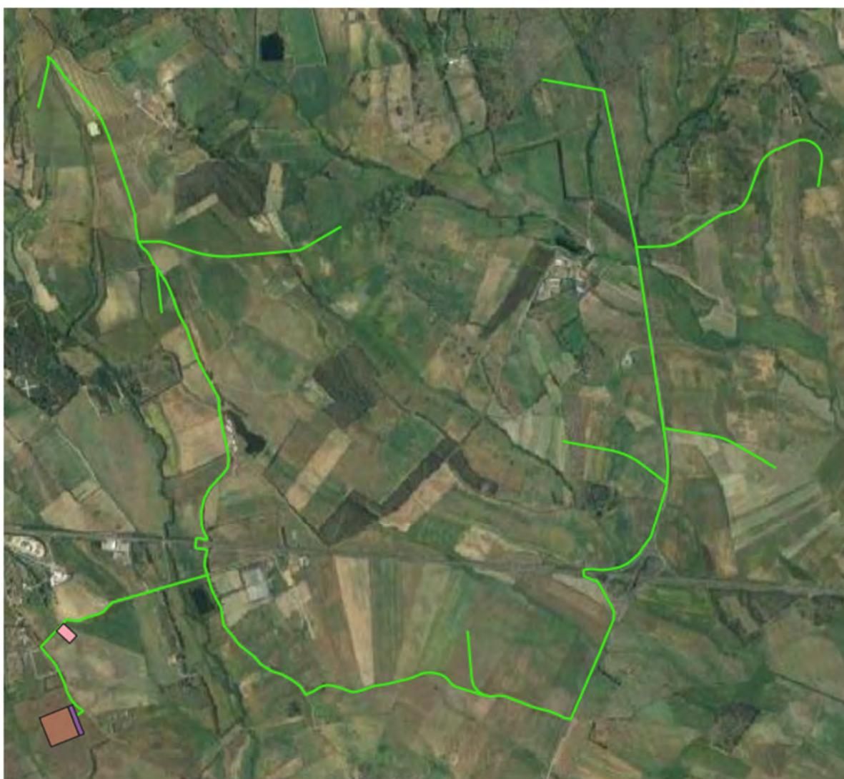
Figura 3.9: Cavidotto MT/AT (in verde) di collegamento con la SE TERNA di nuova realizzazione (in marrone) e il suo ampliamento (in viola). In rosa l'area cabine di raccolta e smistamento.
