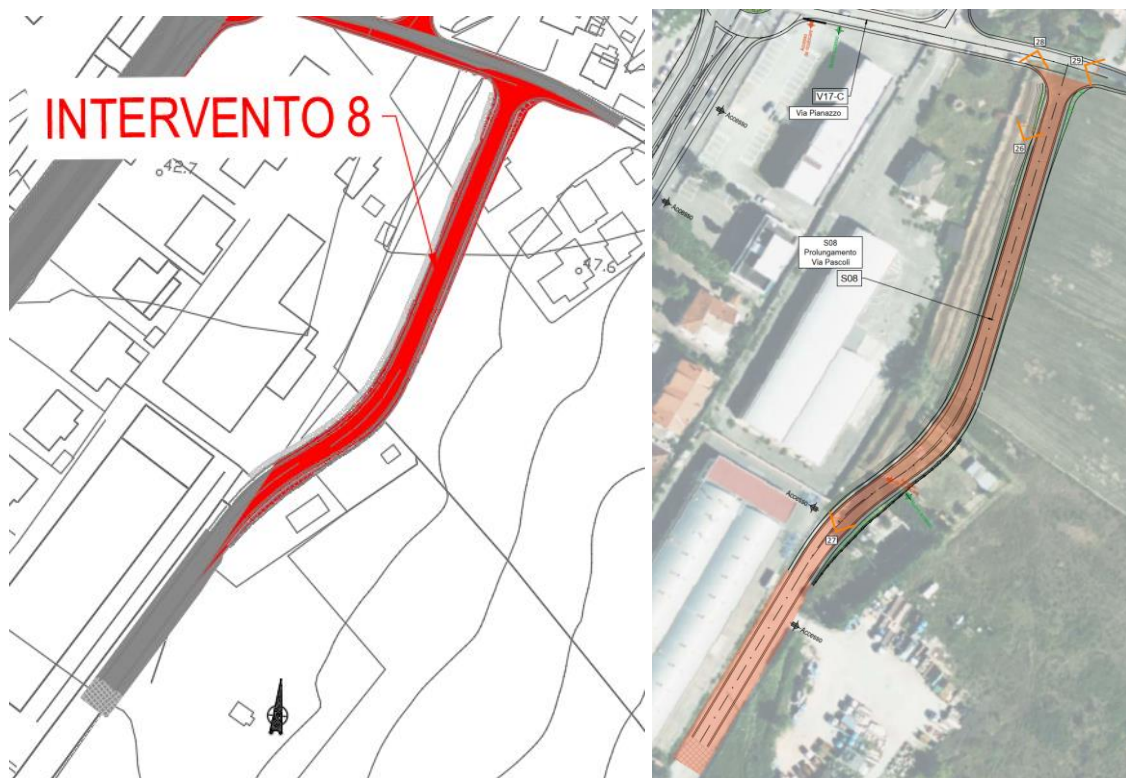
Figura 56 – Prolungamento di Via Pascoli: stato di progetto
