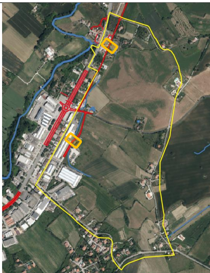
Figura 64 – Canale Rigardarà (in giallo il bacino afferente) con interventi di progetto. La tombinatura verrà realizzata in corrispondenza della zona retinata in arancione.
