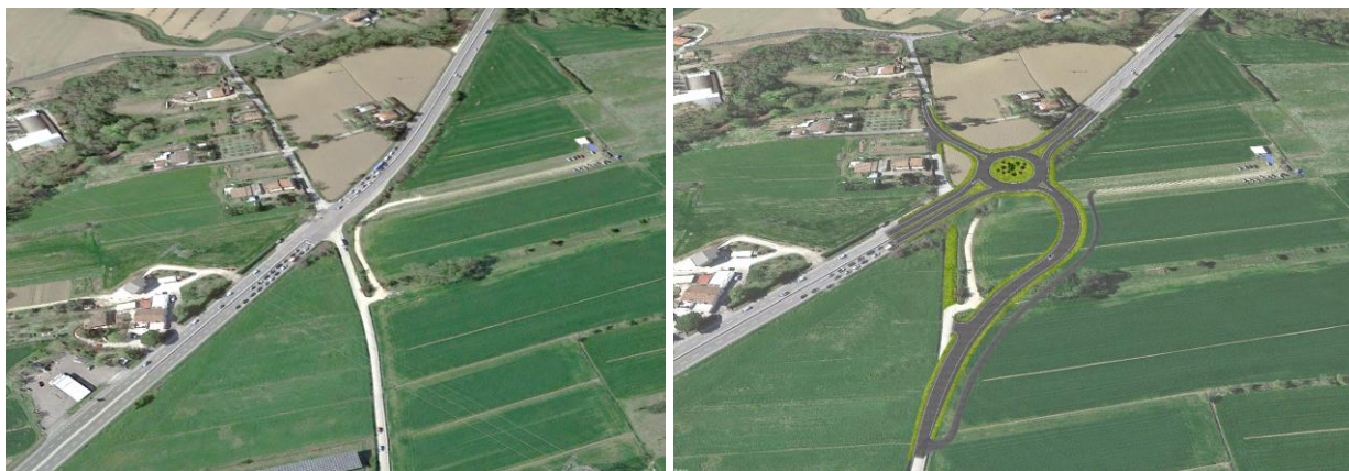
Figura 70 – Intervento 7: confronto stato attuale (sulla sinistra) e di progetto (sulla destra) con mitigazione a verde del tratto stradale dismesso.
