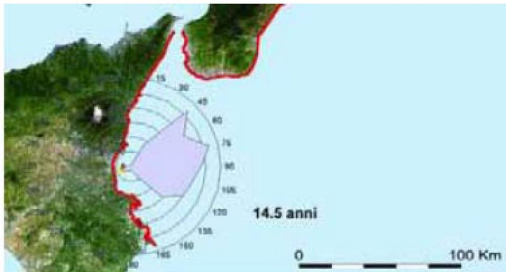
Figura 36. Rappresentazione del clima delle onde basse registrato presso la boa onda metrica di Catania
