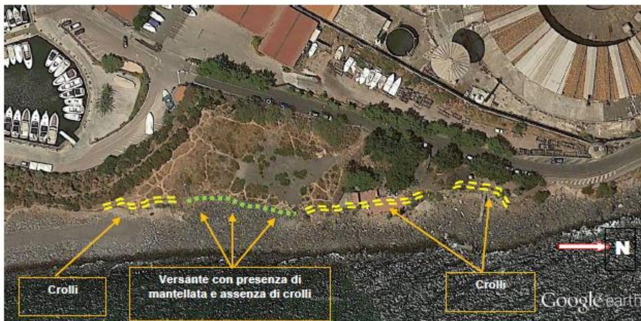
Figura 22. Immagine satellitare dell'area in esame con evidenza (tratteggiato giallo) delle zone soggette a fenomeni di dissesto dovuti a crollo per scalzamento del piede causato dalle mareggiate, laddove non è presente la mantellata di protezione costituita da blocchi lavici
