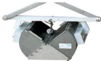
Figura 12. Benna manuale di tipo Van-Veen
