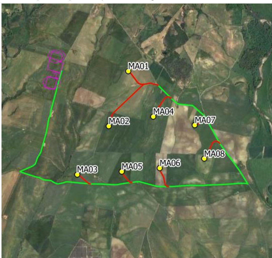
Figura 3.9: Cavidotto (in verde) di collegamento con la nuova SE TERNA (in magenta). In rosso le piste di accesso e in giallo gli aerogeneratori.
