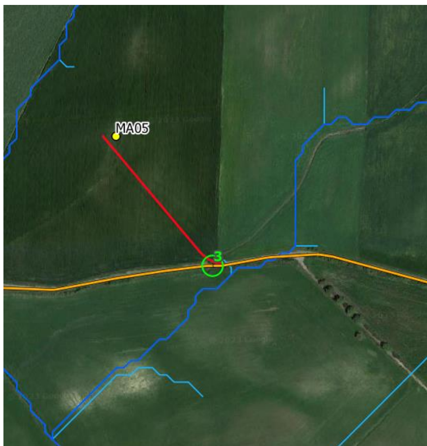
Figura 7.3: Interferenza n.3 lungo la viabilità da adeguare (in arancione) e un corso d'acqua. In blu e celeste l'idrografia estratta dall'analisi del DEM.
