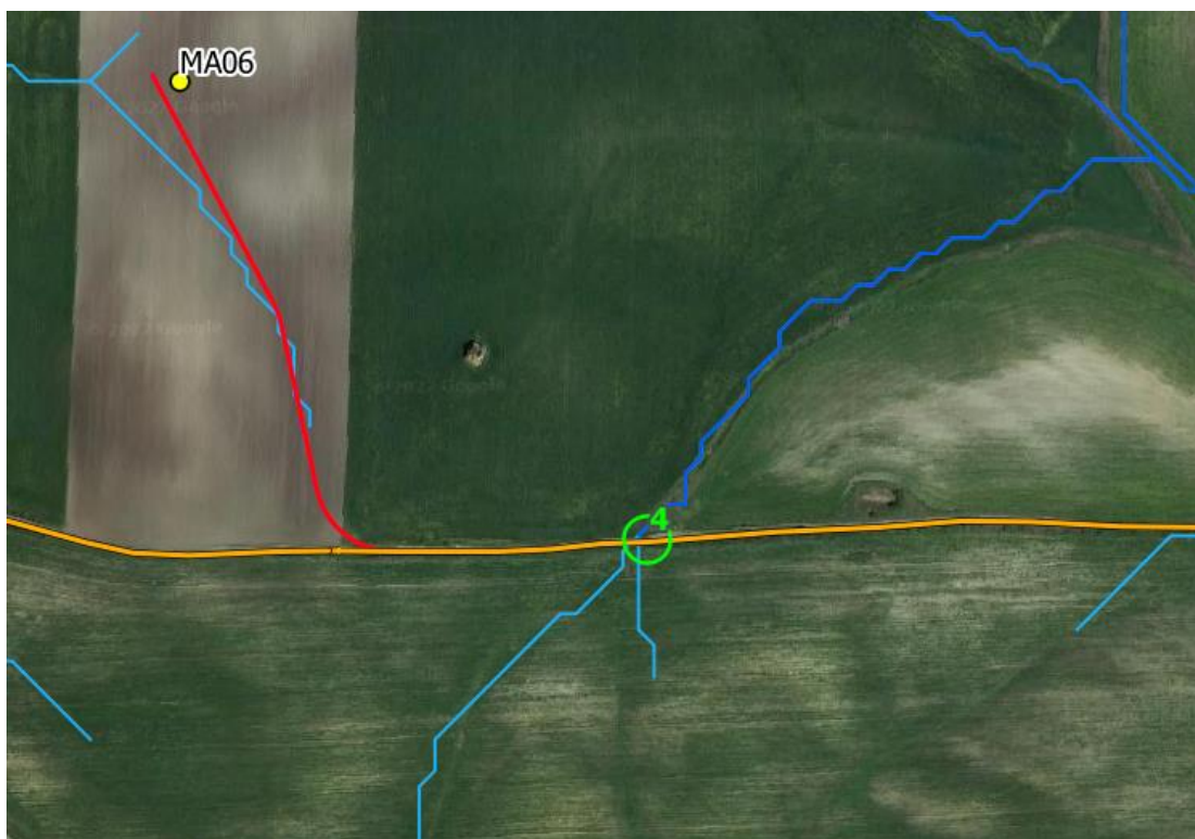
Figura 7.4: Interferenza n.4 lungo la viabilità da adeguare (in arancione) e un corso d'acqua. In blu e celeste l'idrografia estratta dall'analisi del DEM.
