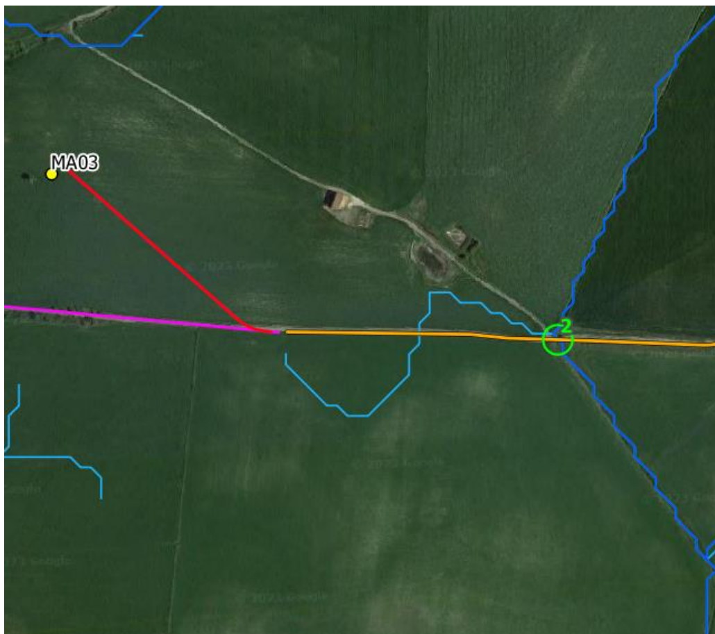
Figura 7.2: Interferenza n.2 lungo la viabilità da adeguare (in arancione) e un corso d'acqua. In blu e celeste l'idrografia estratta dall'analisi del DEM.
