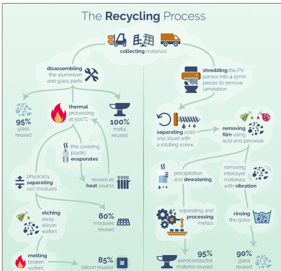
**Figura 94.** Il processo di riciclo dei moduli fotovoltaici a base silicea (lato sx dell'immagine) e dei moduli a film sottile (lato dx dell'immagine). Fonte: [www.greenmatch.co.uk/blog/2017/10/the-opportunities-of-solar-panel-recycling](http://www.greenmatch.co.uk/blog/2017/10/the-opportunities-of-solar-panel-recycling) (Ultimo aggiornamento: marzo 2021).
