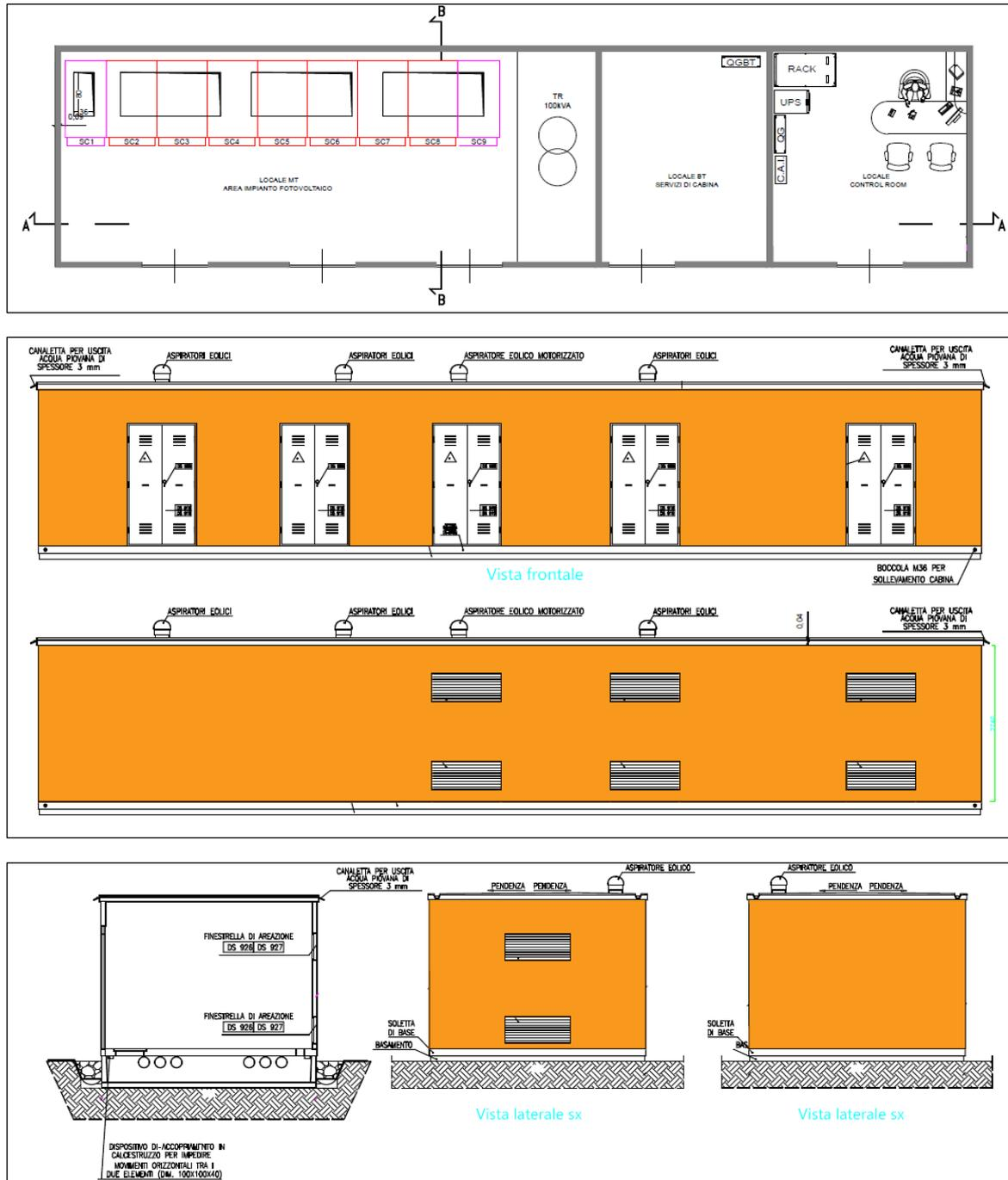
**Figura 75.** Vista in pianta/prospetto/seziona della cabina di smistamento a 30kV e sala di controllo.
