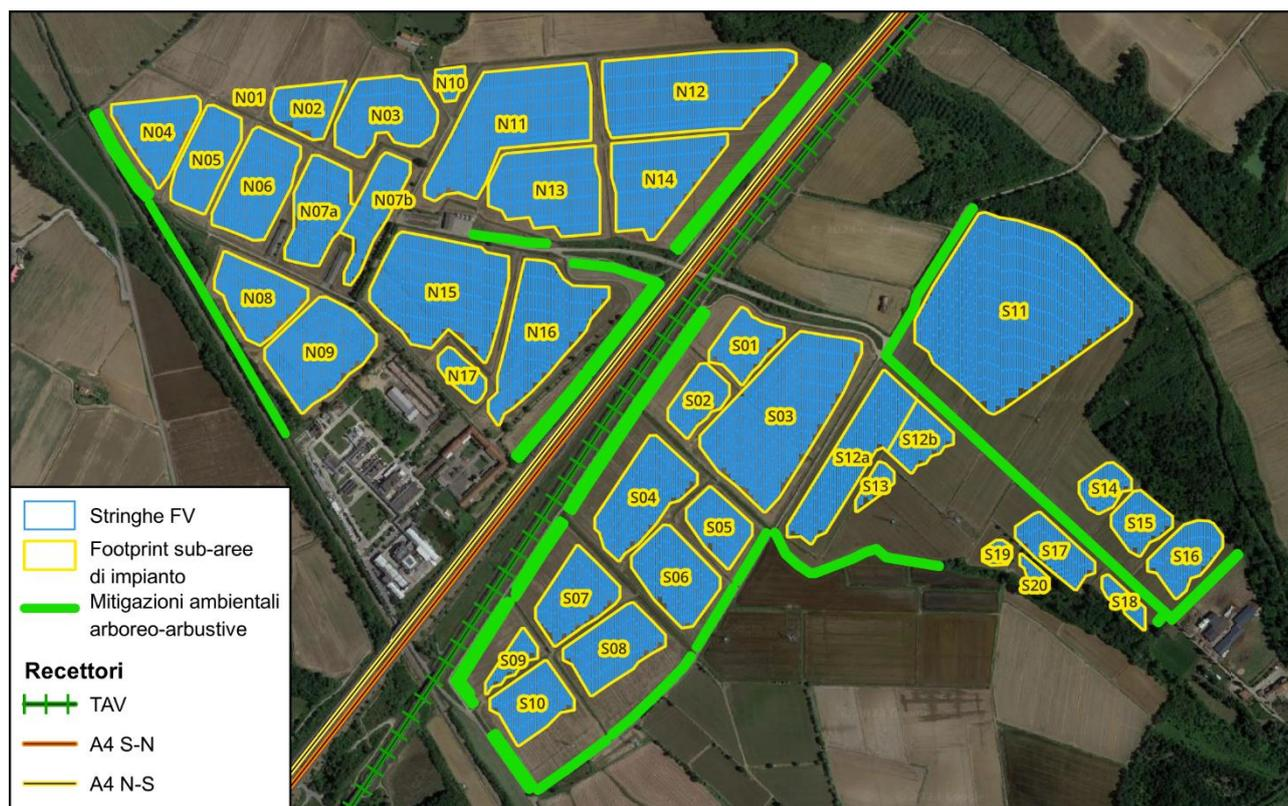
**Figura 135.** Suddivisione e nomenclatura delle singole superfici fotovoltaiche che compongono l'impianto agrivoltaico in progetto al fine della modellistica degli abbagliamenti e disposizione delle fasce vegetate arboreo-arbustive di mitigazione perimetrale.
