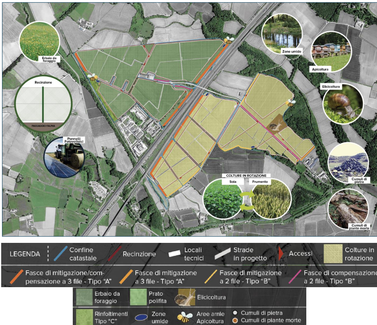
Figura 25. Distribuzione spaziale della proposta agrivoltaica del progetto (rif. FTV22CP05-AMB-R-08c). Le linee arancioni viola e gialle, rappresentate in planimetria, identificano gli ambiti di piantumazione di fasce boscate e filari vegetati con sesto di impianto tipologico rappresentato nella parte bassa dell'immagine (e dei quali viene data ampia trattazione al Cap.6.2).
