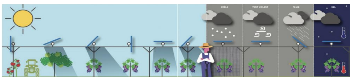
Figura 22. Illustrazione tipologica del funzionamento di un sistema Agrivoltaico (Fraunhofer, 2020).
