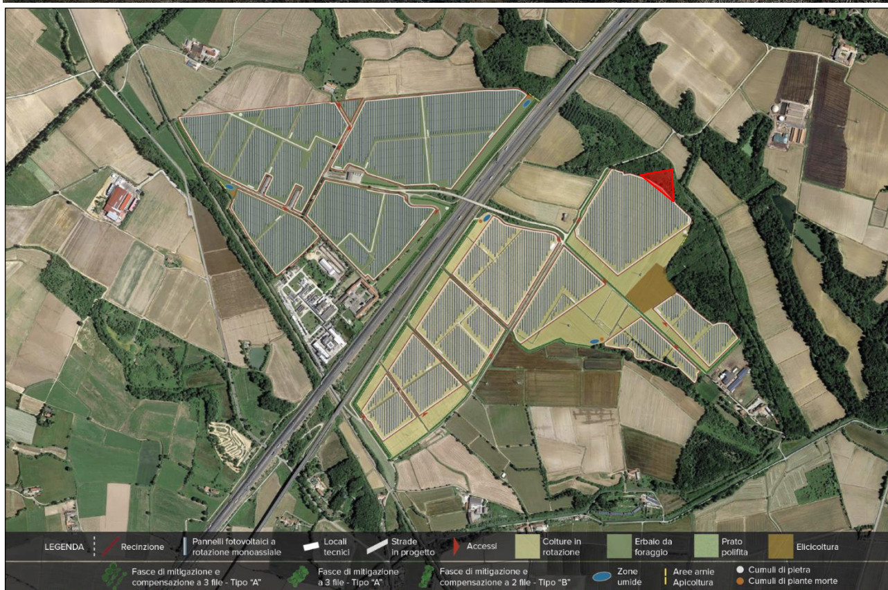
Figura 43. Sovrapposizione di layout di progetto agrivoltaico su ortofotocarta con evidenza dei margini boscati esistenti (fotografia panoramica nella parte sommitale della figura scattata nel margine est di progetto) e delle fasce vegetate di mitigazione.
