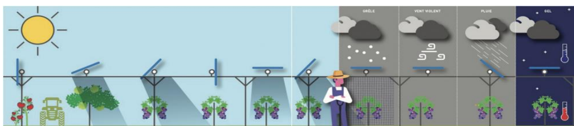
Figura 50. Illustrazione tipologica del funzionamento di un sistema Agrivoltaico (Fraunhofer, 2020).
