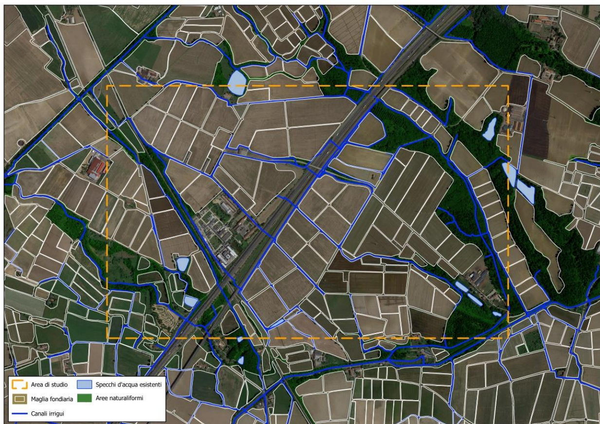
Figura 3. Assetto della maglia fondiaria dell'area di progetto a seguito del ripristino degli arginelli minori.
