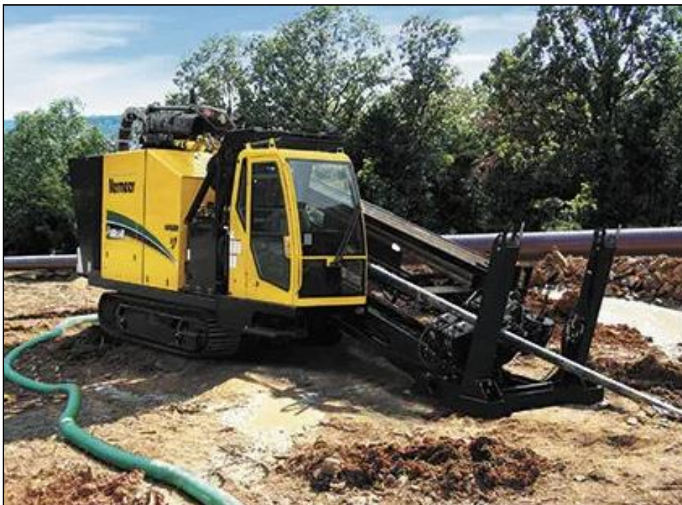
Figura 2. Esempio di macchina perforatrice per T.O.C.
