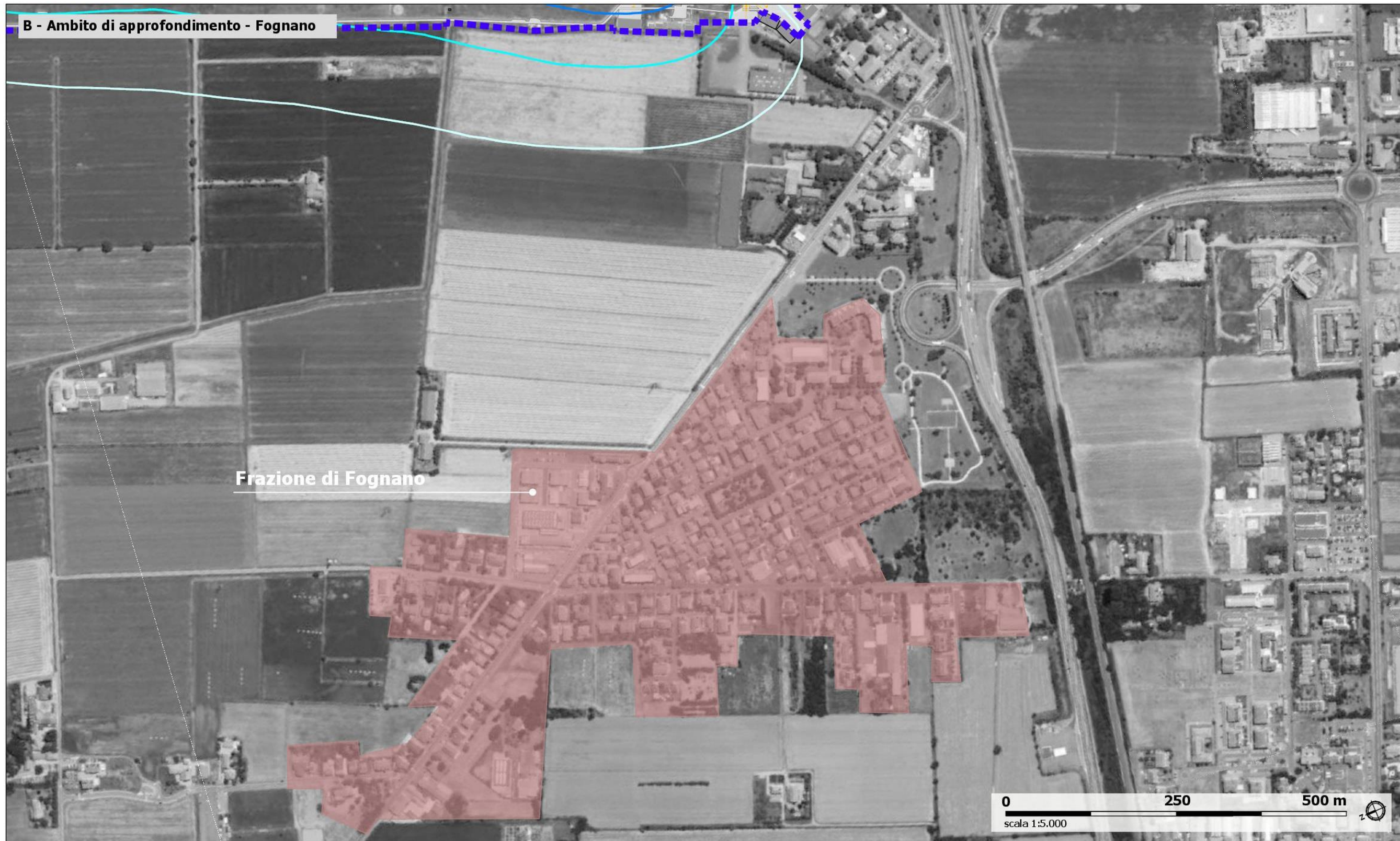
Figura 2-6 Output del modello di simulazione: Curve isofoniche in Leq(A) – periodo notturno relative all'abitato di Fognano (Testata pista 02)
