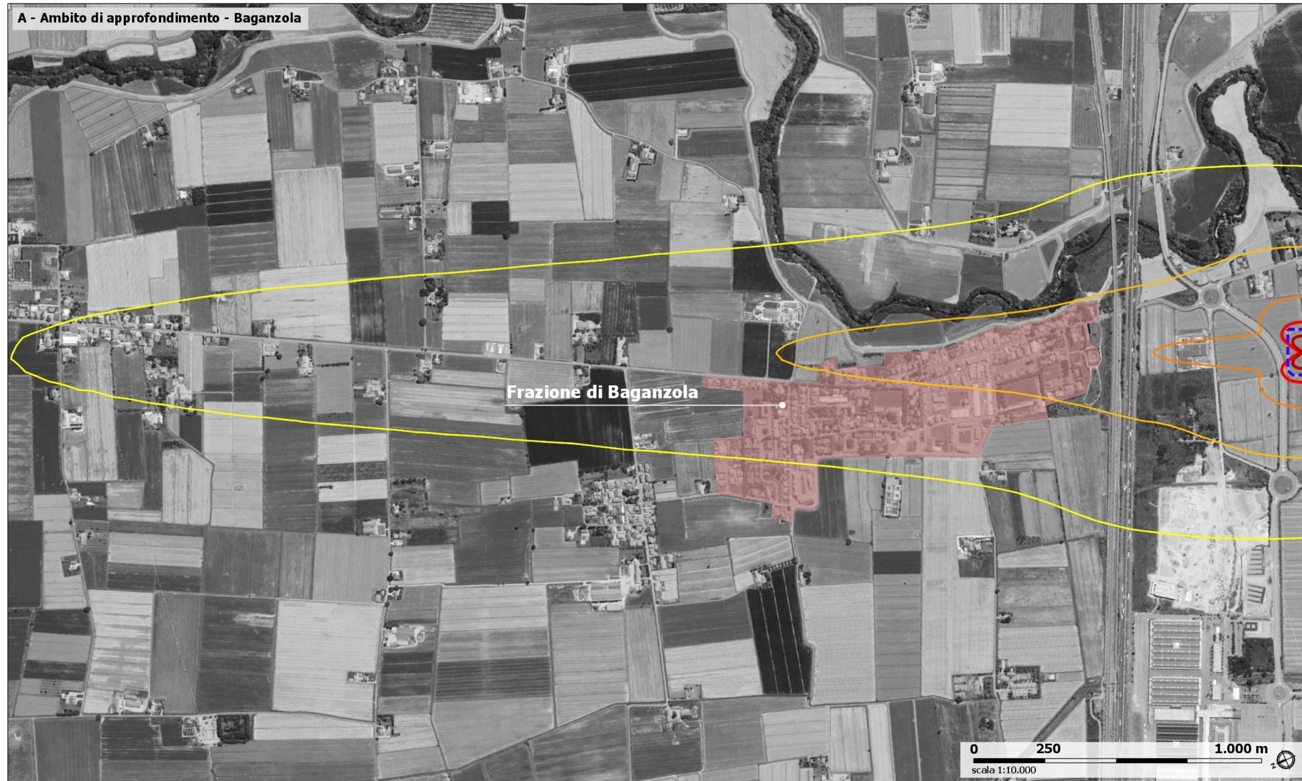
Figura 2-2 Output del modello di simulazione: Curve isofoniche in Leq(A) – periodo diurno relative all'abitato di Baganzola (Testata pista 20)
