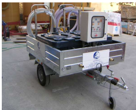
Figura 5-2 Esempio di impianto di aspirazione carrellabile
