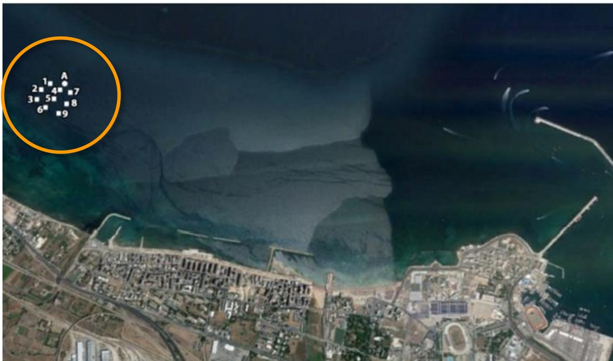
Figura 5-12 Allocazione delle 9 stazioni di conta fasci (quadrati bianchi 1-9, ognuna replicata 10 volte nell'intorno del punto georeferenziato), in corrispondenza del sistema di balisage a Nord del porto di Bari. I cerchi bianchi indicano il sistema di balisage impiantato (balisage A, n. 7 paletti)
