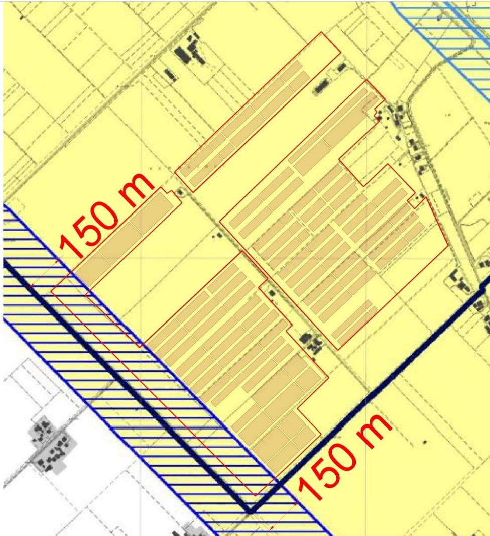
Figura 19 – Rappresentazione grafica della distanza (150 m) lasciata libera e ineditata attraverso la sovrapposizione delle serre di progetto rispetto al “Canale della Selcella” su stralcio cartografico della Tavola B del PTRP
