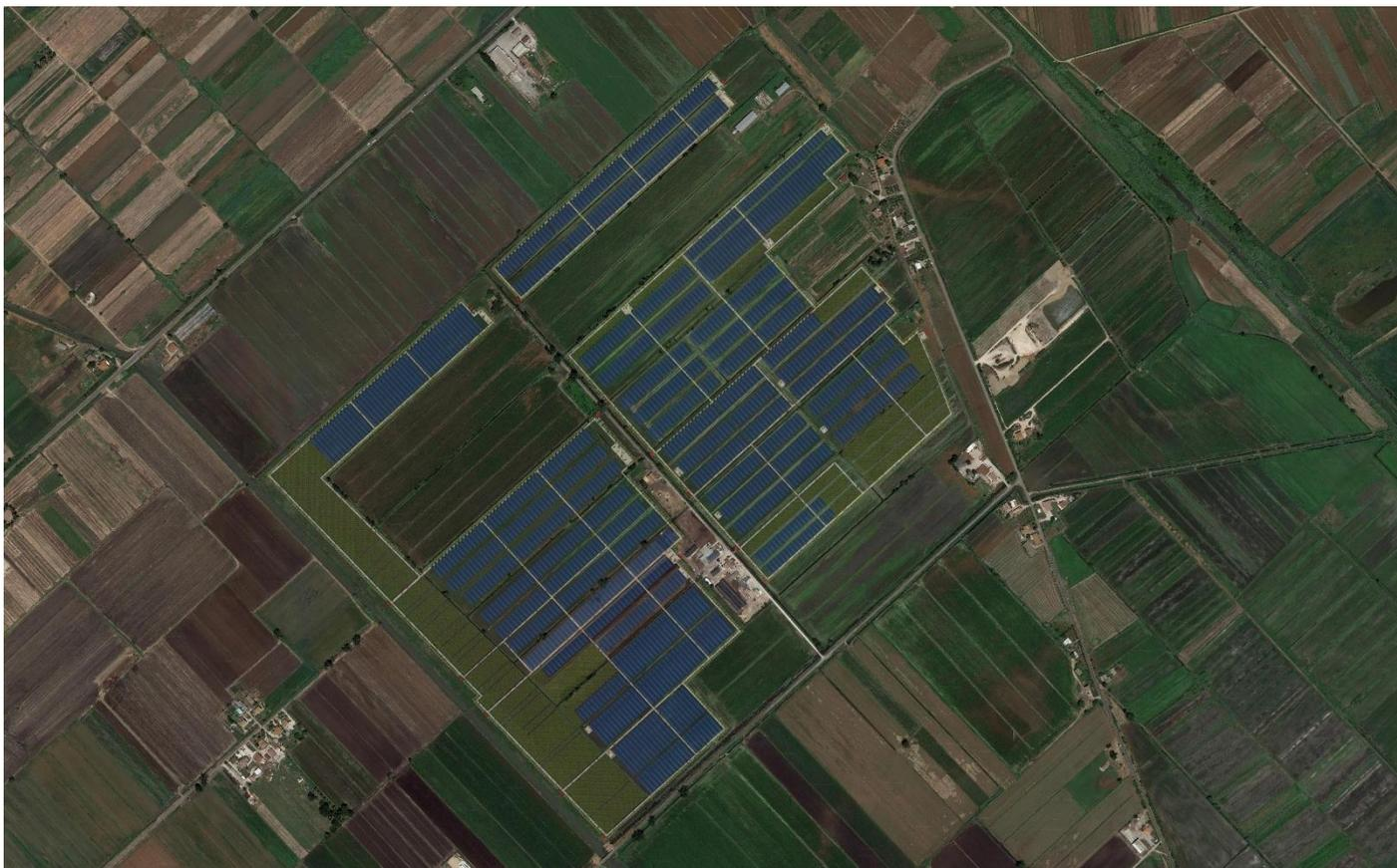
*Figura 10 – Layout di impianto su ortofoto satellitare con le opere di mitigazione perimetrale di larghezza 5 metri*
