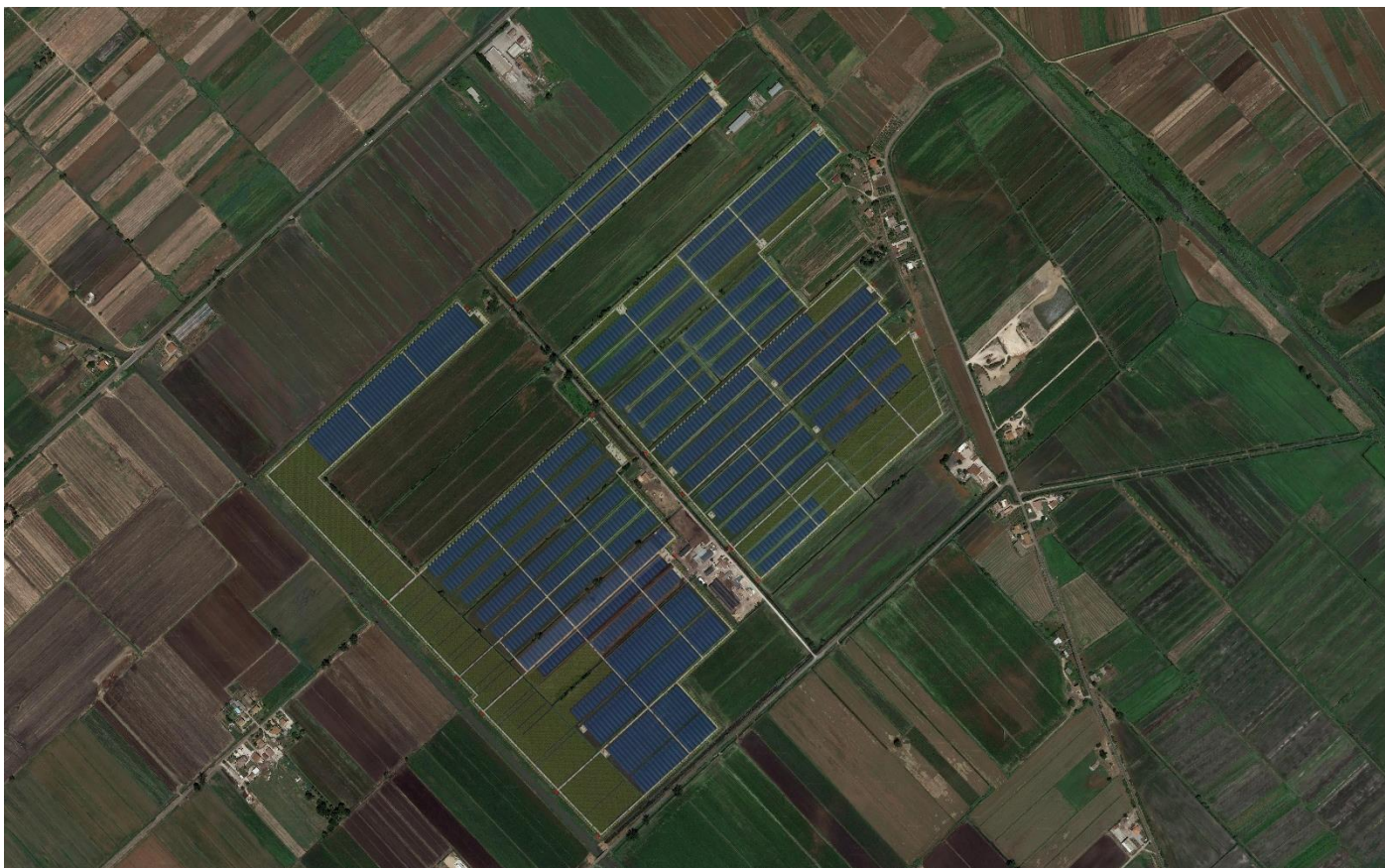
Figura 10 – Layout di impianto su ortofoto satellitare con le opere di mitigazione perimetrale di larghezza 5 metri
