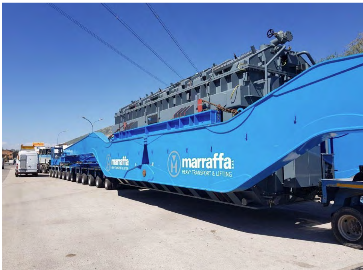
Figura 40: Esempio di "trasporto con spalle" di un trasformatore (Girder Bridge System)
