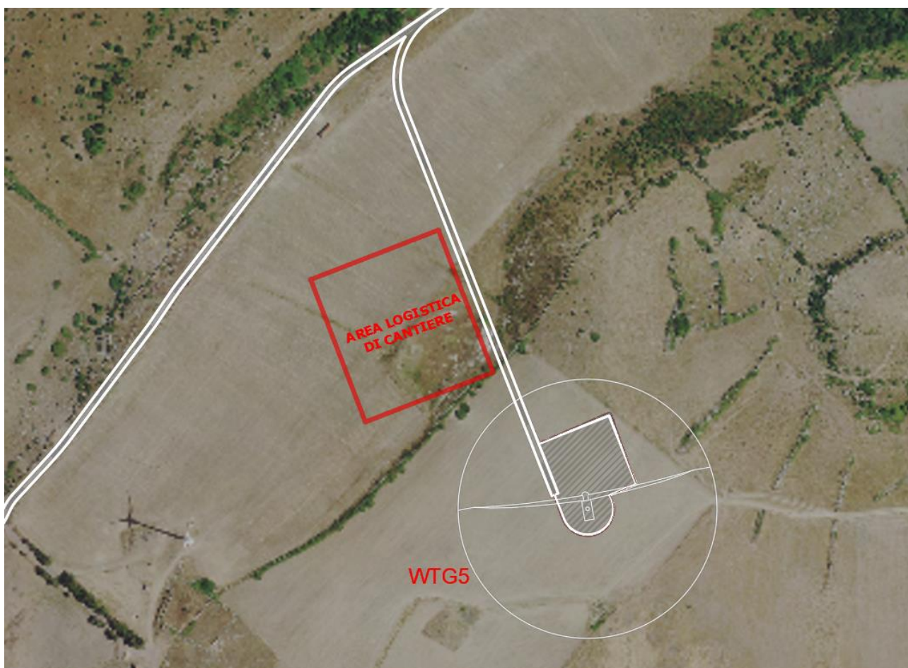
Figura 5.15 – Possibile ubicazione dell’area di cantiere generale
