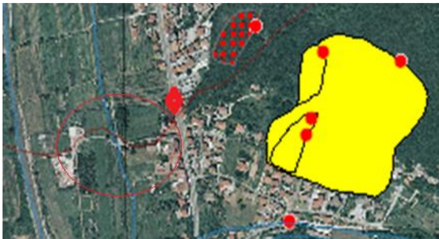
Figura 2.2: Carta dei Dissesti del Progetto IFFI (◆ Imbocco Galleria e ○ area tratto stradale di imbocco; ● frana; ■ aree soggette a crollo; ■ scivolamento)
