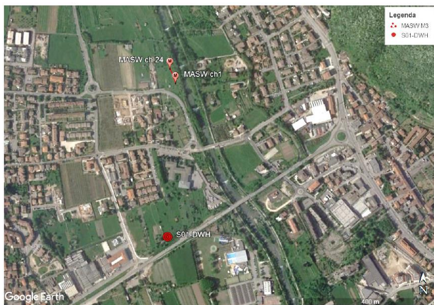
Figura 4.13: Ubicazione prova Down-Hole (DWH) e prova sismica MASW
