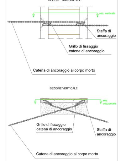
**PARTICOLARE ANCORAGGIO PONTILI GALLEGGIANTI CON PALI** scala 1:25
