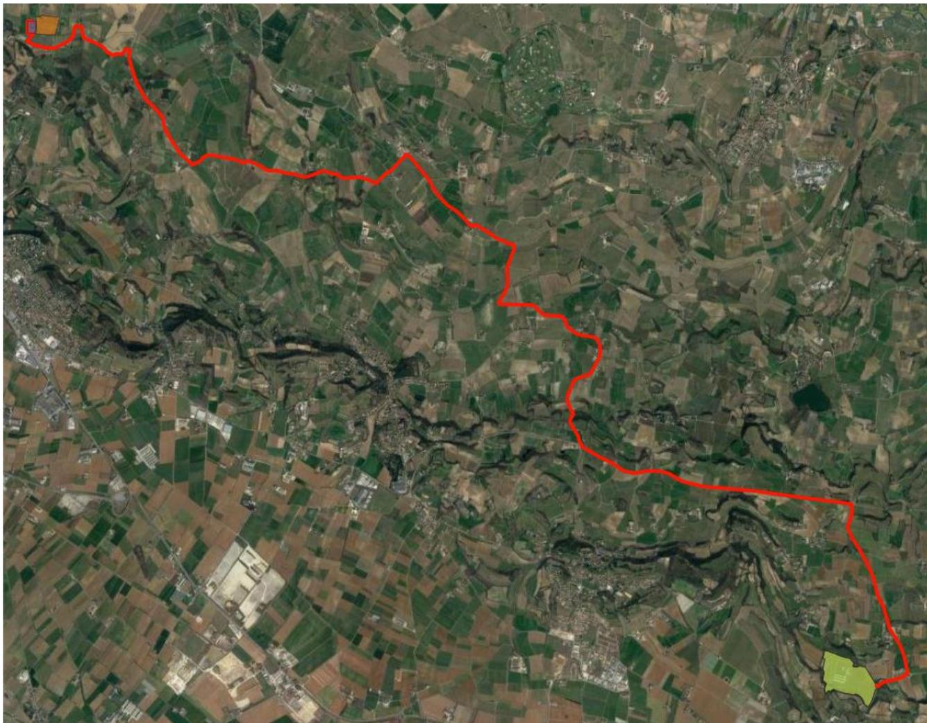
Nell’immagine satellitare di cui sopra, l’area occupata dall’impianto fotovoltaico è evidenziata in verde, mentre è indicato con una linea rossa l’elettrodotto collegato in antenna a 36 kV su un futuro ampliamento della Stazione Elettrica (SE) (in colore arancione) della RTN a 36/132 kV denominata “Lonato” come indicato nella Soluzione Tecnica Minima Generale.
