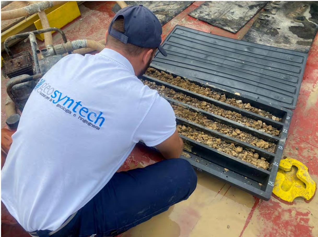
Inoltre, sulle carote estratte dai sondaggi a carotaggio continuo, al fine di identificare i valori di resistenza a compressione semplice (*UCS*) e di resistenza al taglio non drenata (*Su*) dei litotipi coesivi, sono state eseguite delle prove speditive mediante *Pocket Penetrometer* e *Pocket Vane* per valutare la resistenza alla rottura ed a taglio dei terreni investigati, i cui valori sono riportati nelle stratigrafie di perforazione e riassunti nella tabella seguente.
