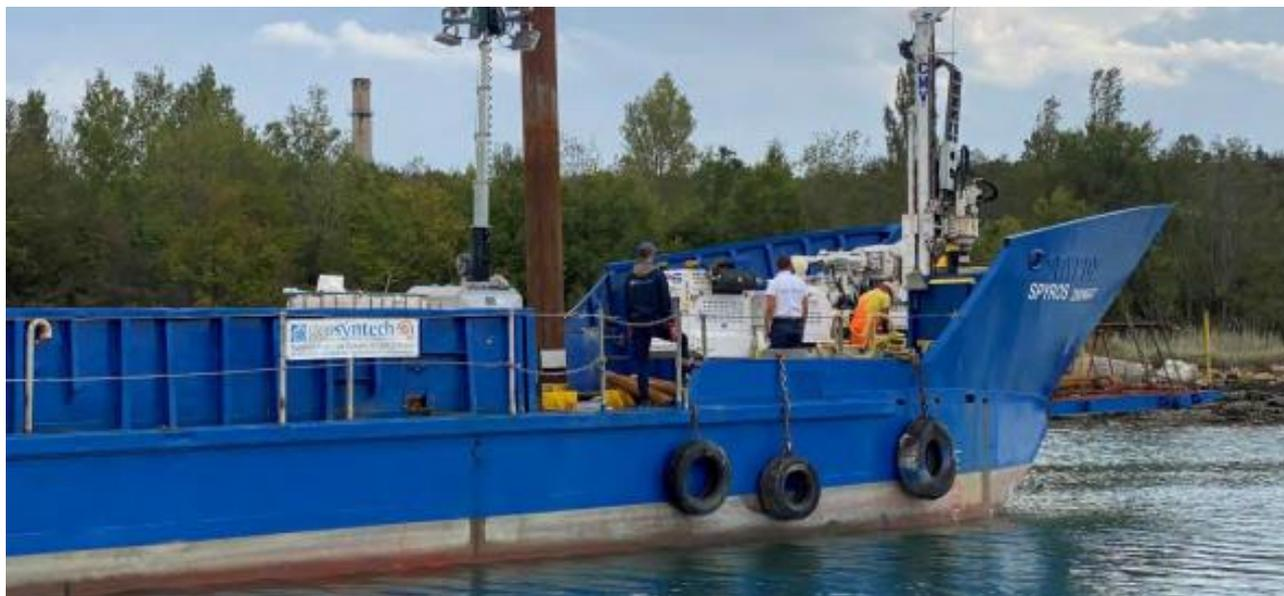
Figura 4.2 – Sonda di perforazione CMV MP6 posizionata su M/B Spyros
