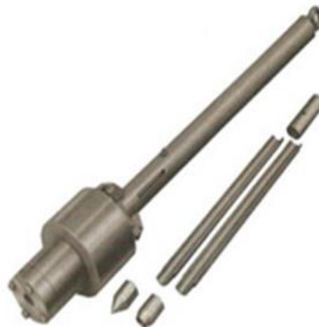
Viene rilevato il numero di colpi N necessari per la penetrazione di tre tratti consecutivi di 15 cm. Il valore NSPT è dato dalla somma dei colpi ottenuti per il 2° e 3° tratto. La prova
