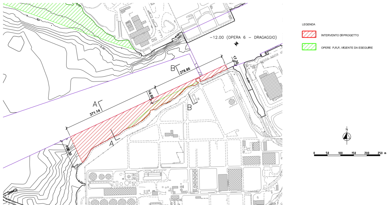
Figura 1-1 Planimetria opere di banchinamento Terminal Noghere come previste da PRP
