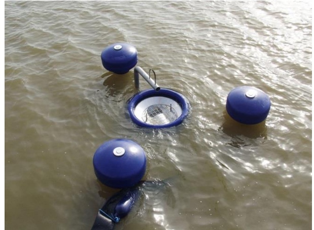
Figura 9: Sfiatore galleggiante (schema e foto)
