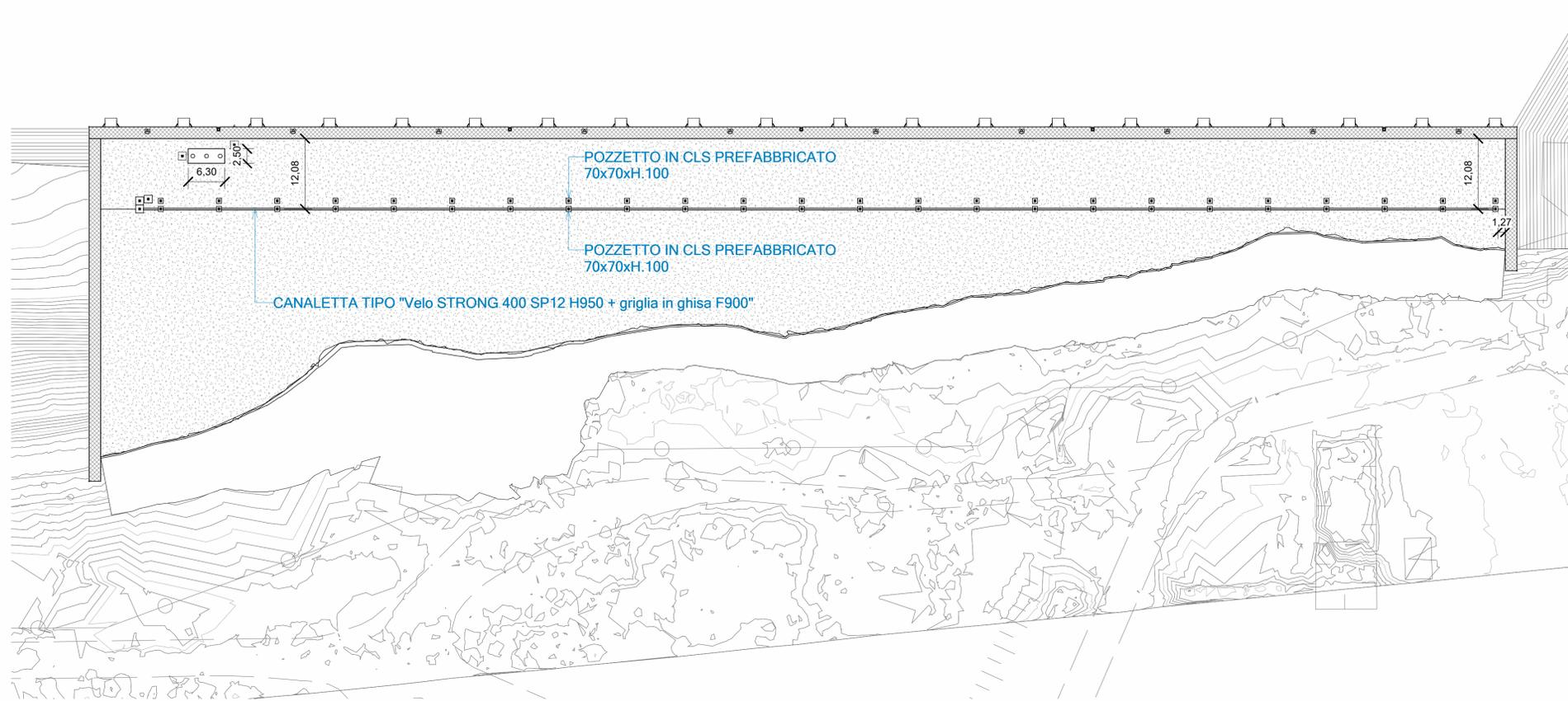
Planimetria delle reti di drenaggio delle acque meteoriche - canalette
