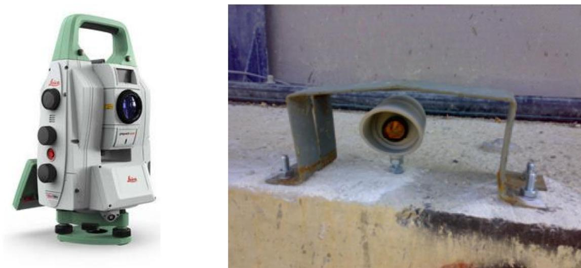
Figura 5.3 – Stazione totale di altissima precisione (a sinistra); mini-prismi (a destra).
