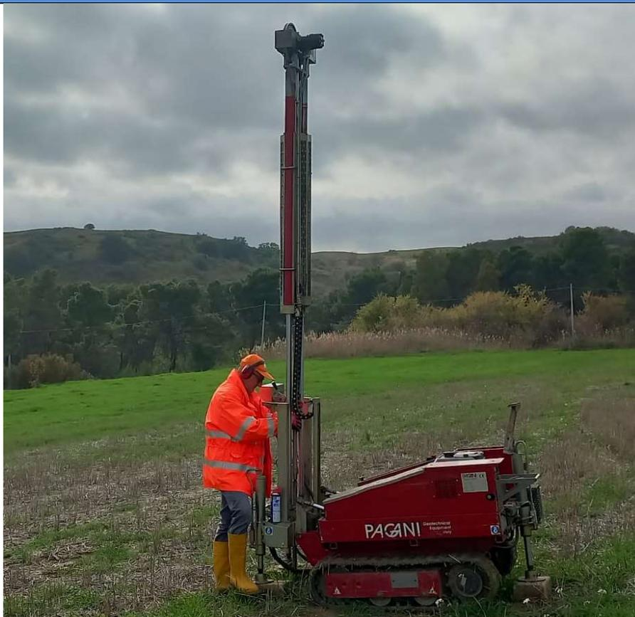
Prova penetrometrica dinamica – PD05
