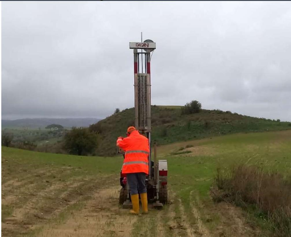
Prova penetrometrica dinamica – PD09
