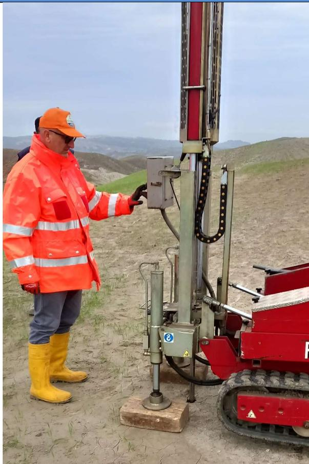
Prova penetrometrica dinamica – PD08
