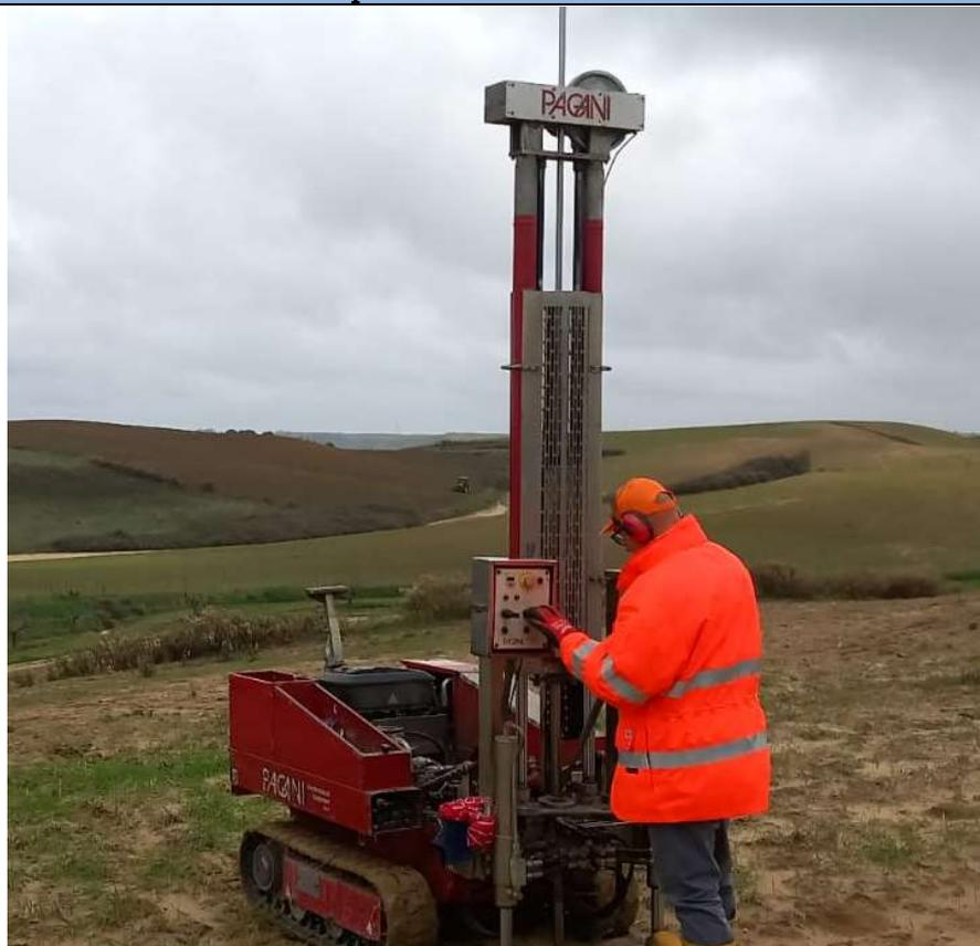
Prova penetrometrica dinamica – PD07
