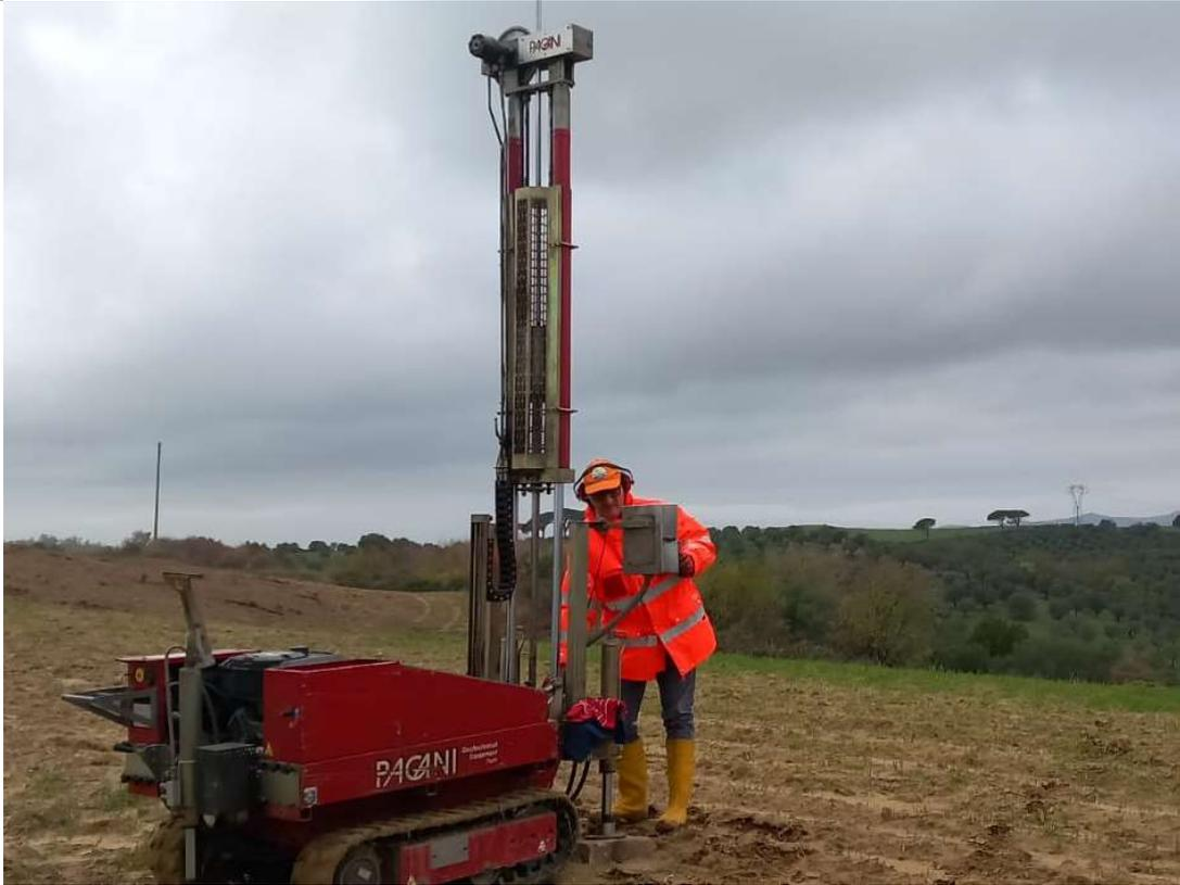
Prova penetrometrica dinamica – PD10
