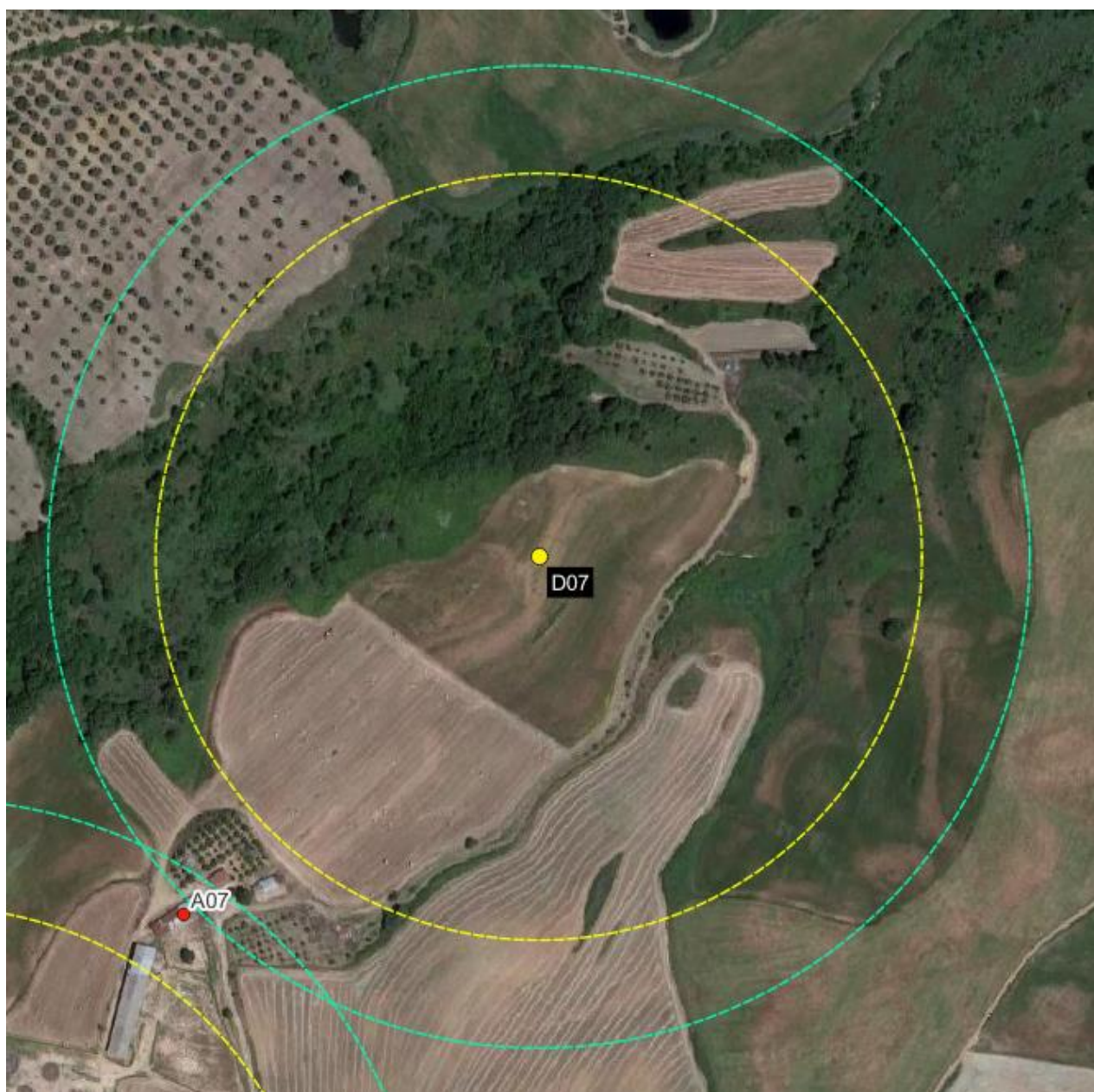
Figura 6-7 – Gittata dell'intera pala (246,6 m) in colore giallo e gittata del frammento di pala (316,0 m) in colore verde, da aerogeneratore D07
