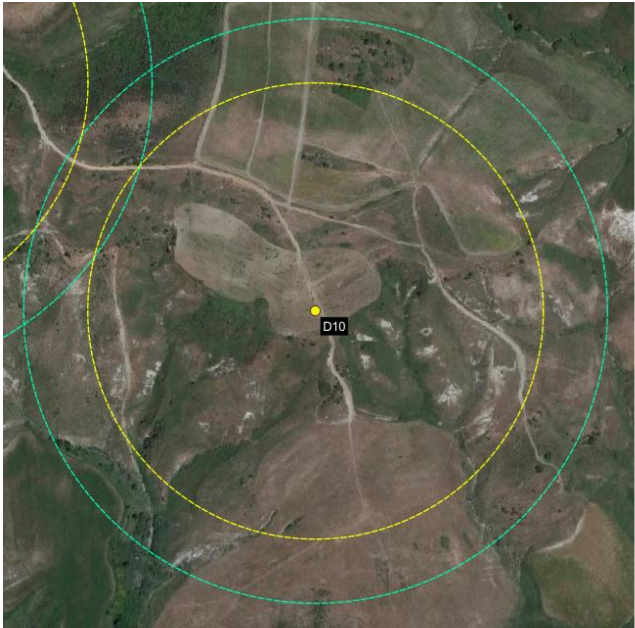
Figura 6-10 – Gittata dell'intera pala (246,6 m) in colore giallo e gittata del frammento di pala (316,0 m) in colore verde, da aerogeneratore D10
