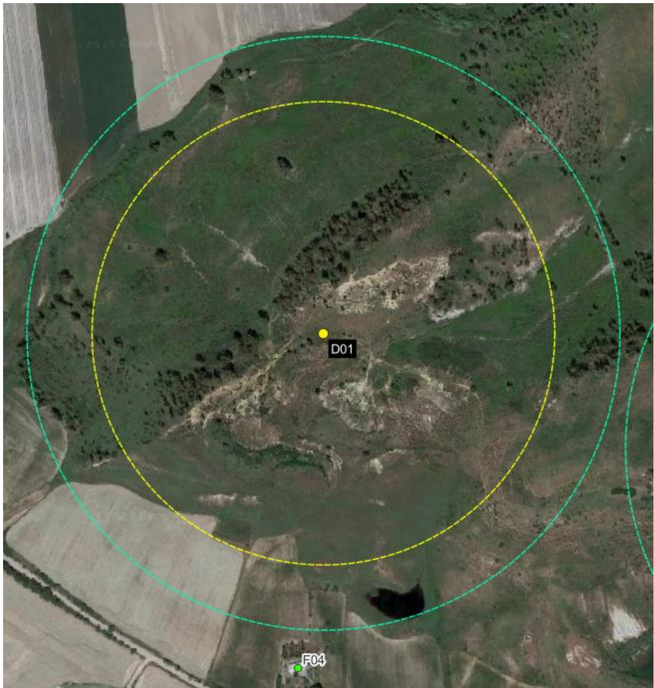
Figura 6-1 – Gittata dell'intera pala (246,6 m) in colore giallo e gittata del frammento di pala (316,0 m) in colore verde, da aerogeneratore D01
