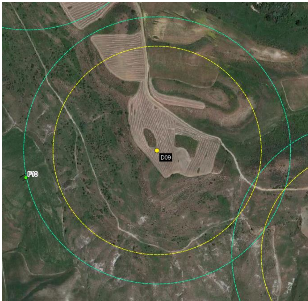
Figura 6-9 – Gittata dell'intera pala (246,6 m) in colore giallo e gittata del frammento di pala (316,0 m) in colore verde, da aerogeneratore D09
