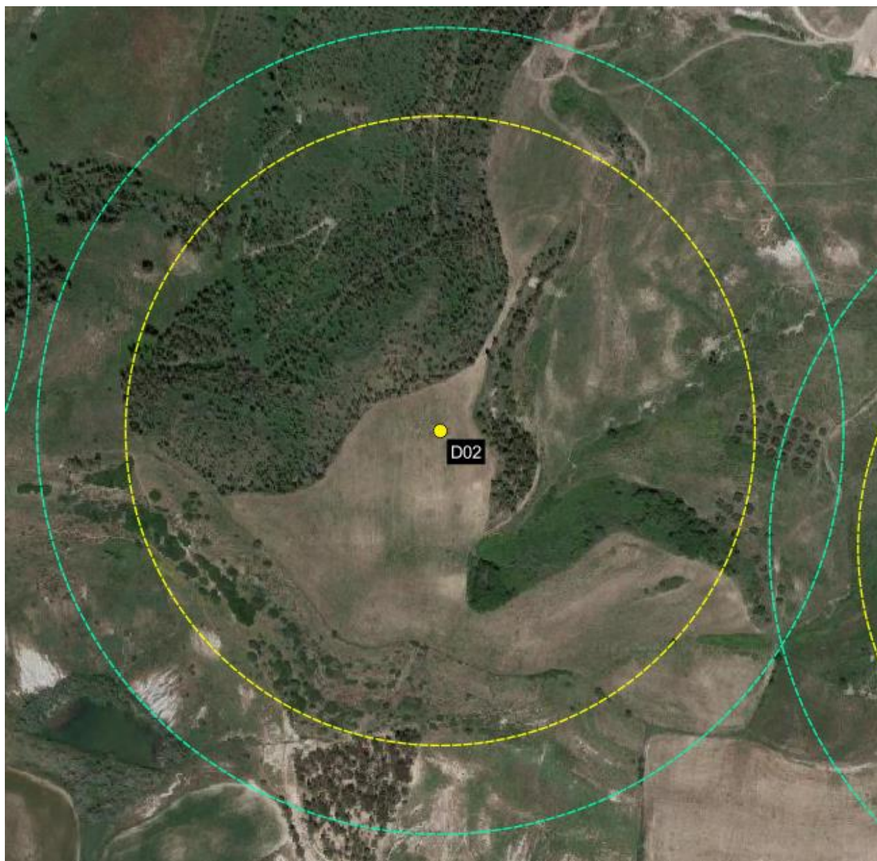
Figura 6-2 – Gittata dell'intera pala (246,6 m) in colore giallo e gittata del frammento di pala (316,0 m) in colore verde, da aerogeneratore D02
