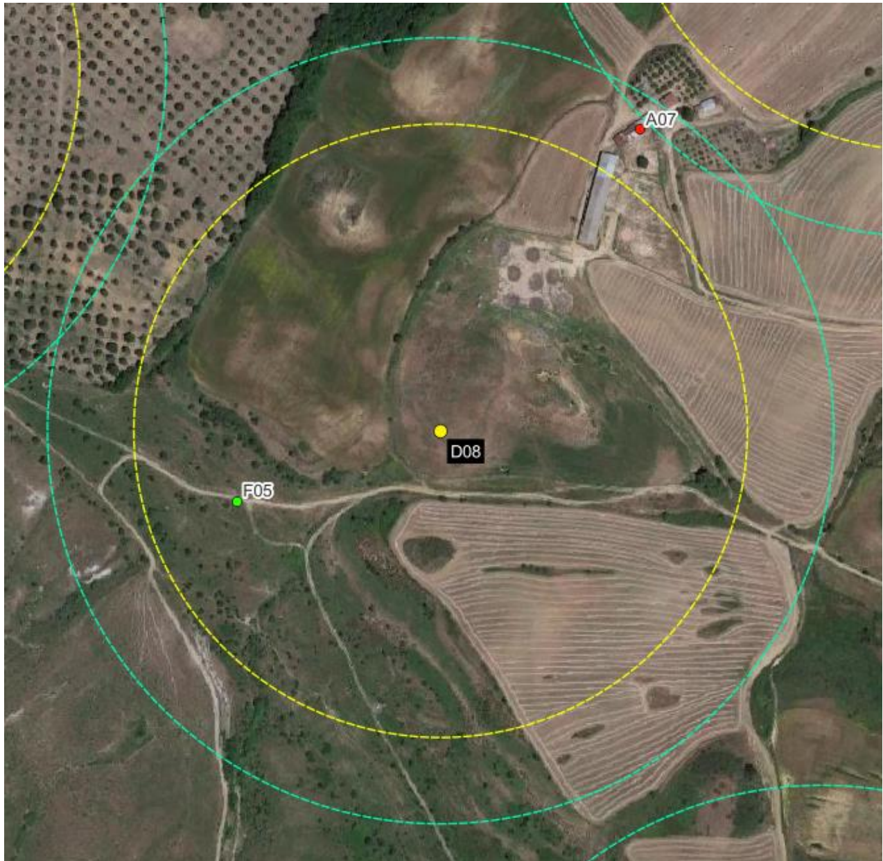
Figura 6-8 – Gittata dell'intera pala (246,6 m) in colore giallo e gittata del frammento di pala (316,0 m) in colore verde, da aerogeneratore D08
