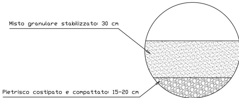
SEZIONE IN RILEVATO
