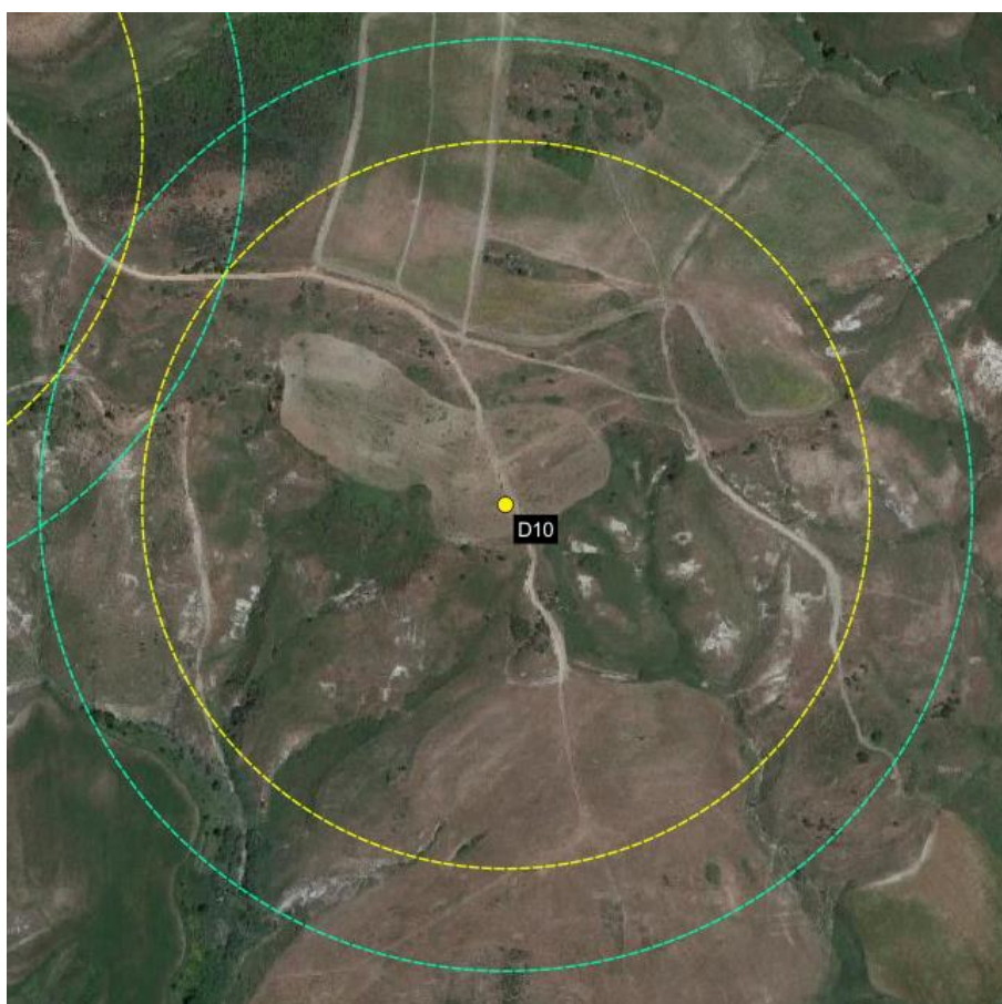
Figura 8-11 – Gittata dell'intera pala (246,6 m) in colore giallo e gittata del frammento di pala (316,0 m) in colore verde, da aerogeneratore D10
