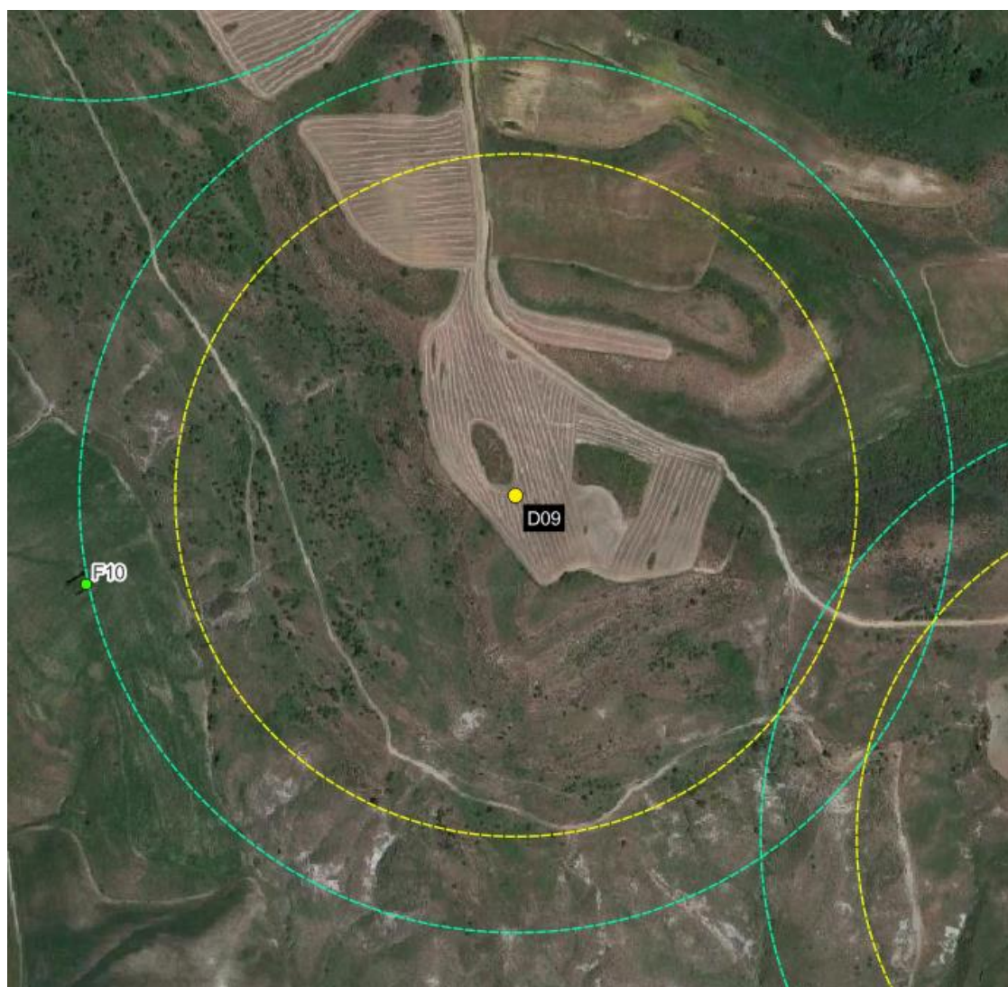
Figura 8-10 – Gittata dell'intera pala (246,6 m) in colore giallo e gittata del frammento di pala (316,0 m) in colore verde, da aerogeneratore D09
