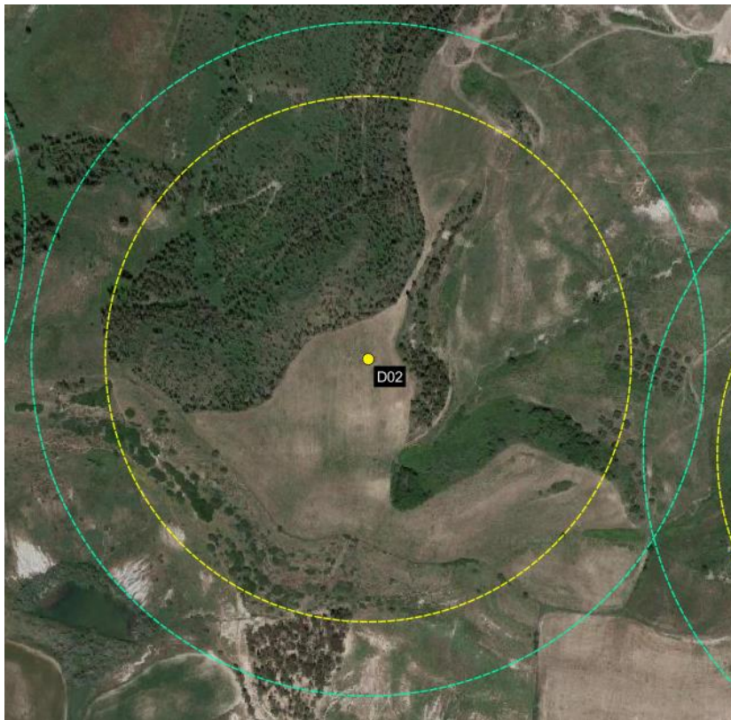
Figura 8-3 – Gittata dell'intera pala (246,6 m) in colore giallo e gittata del frammento di pala (316,0 m) in colore verde, da aerogeneratore D02
