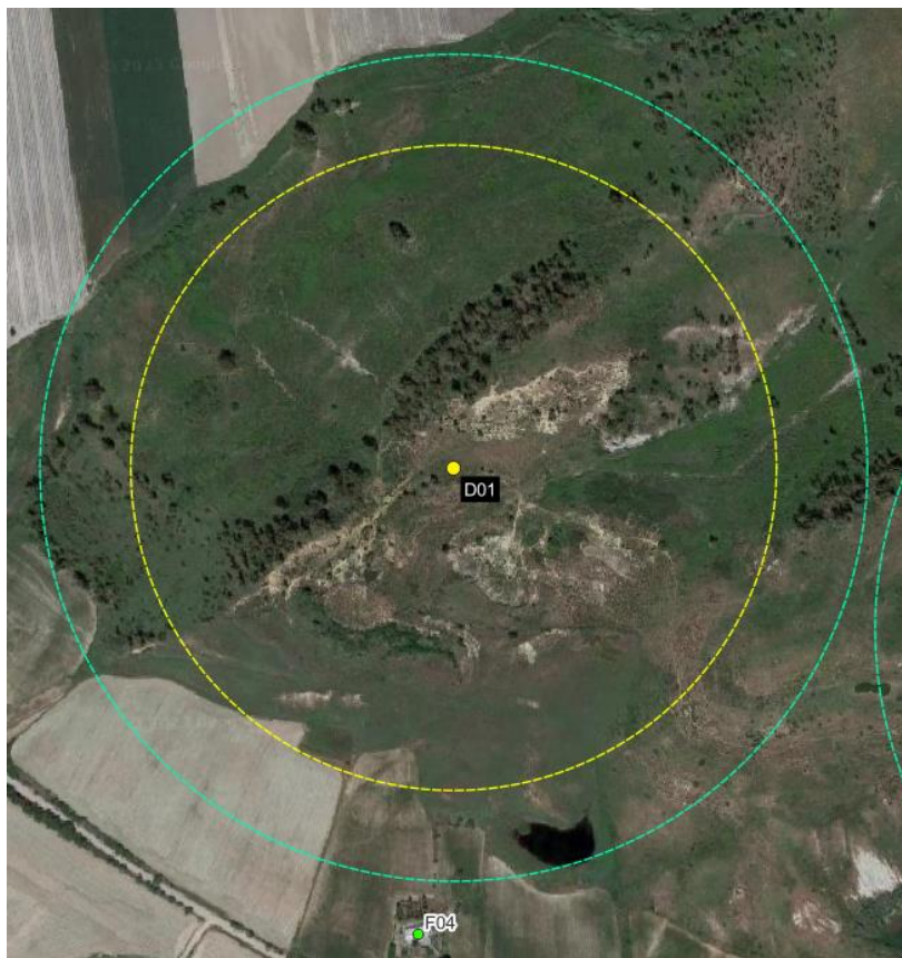
Figura 8-2 – Gittata dell'intera pala (246,6 m) in colore giallo e gittata del frammento di pala (316,0 m) in colore verde, da aerogeneratore D01
