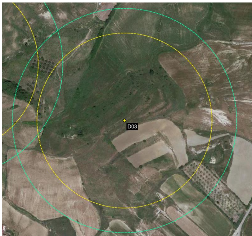
Figura 8-4 – Gittata dell'intera pala (246,6 m) in colore giallo e gittata del frammento di pala (316,0 m) in colore verde, da aerogeneratore D03
