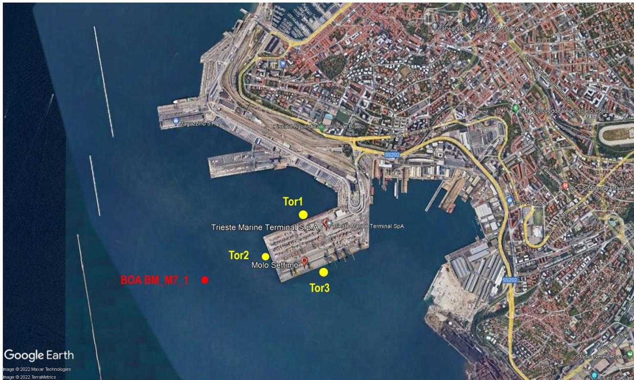
Figura 5 Posizionamento delle sonde per la rilevazione della torbidità all'interno dell'area di cantiere e della boa previste dal presente PMA.
