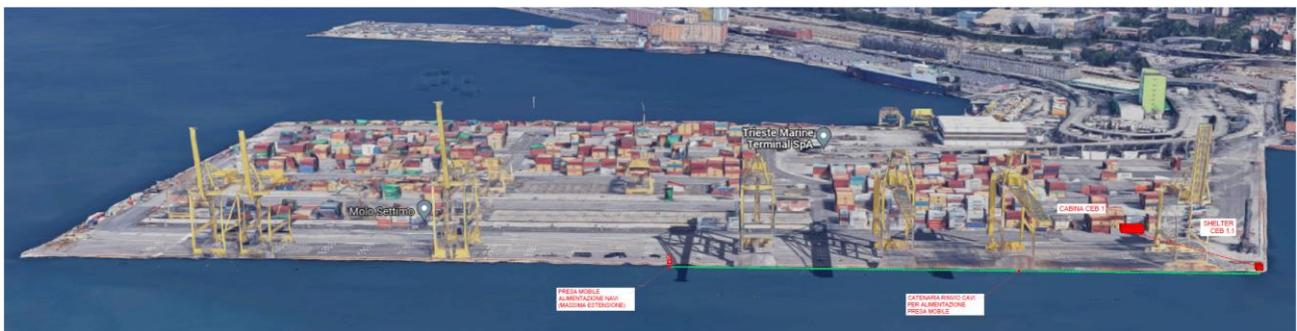
L'intervento prevede la realizzazione dei punti di alimentazione elettrica in banchina per le navi all'ormeggio lungo la banchina sud del Molo 7. Le interferenze prevedibili sono con le lavorazioni elettriche (previste nel presente PFTE) sulle cabine e sull'anello ABC, ai cantieri puntuali per il ripristino di piastre ammalorate (in
