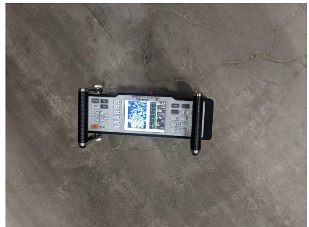
Fasi acquisizione tomografica ultrasonica
