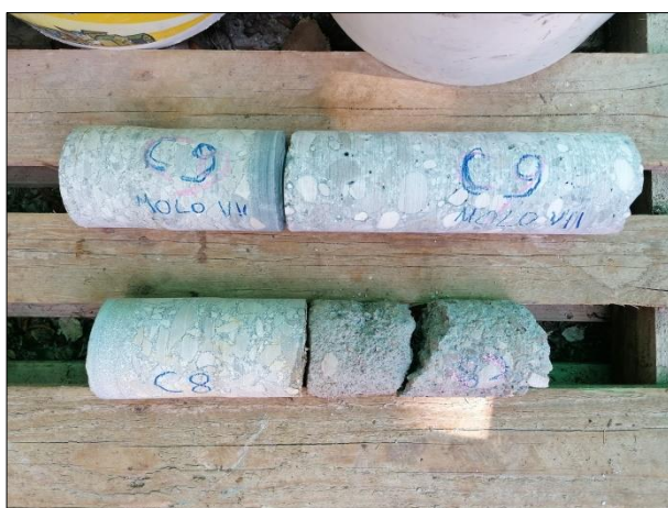
Campioni prelevati C8 e C9 e prova di carbonatazione.
