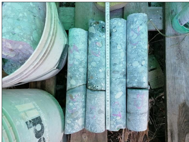
Campioni prelevati C1 C2 C3 C4 e prova di carbonatazione.
