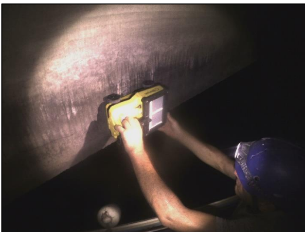
Una fase preliminare di rilievo delle armature (immagine a sx) e una fase della prova tomografica (immagine a dx).
