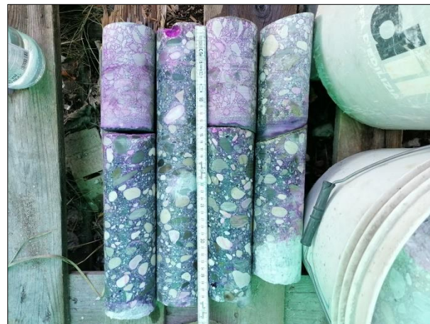
Campioni prelevati C1 C2 C3 C4 e prova di carbonatazione.
