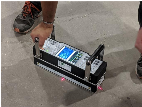
Fasi acquisizione tomografica ultrasonica
