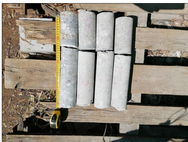
Campioni prelevati C5 C6 C7 C10 e prova di carbonatazione.
