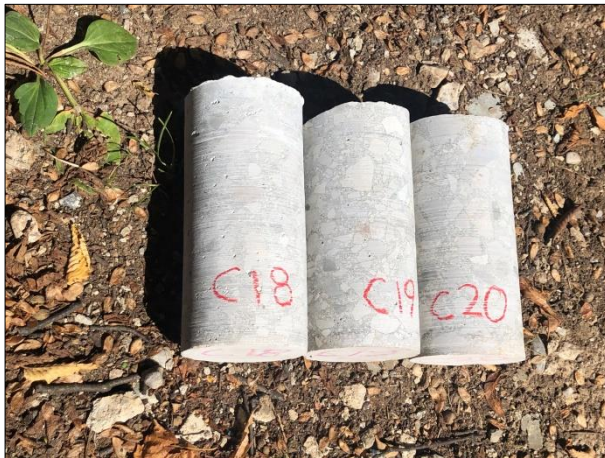
Campioni prelevati C18 C19 C20 e prova di carbonatazione.
