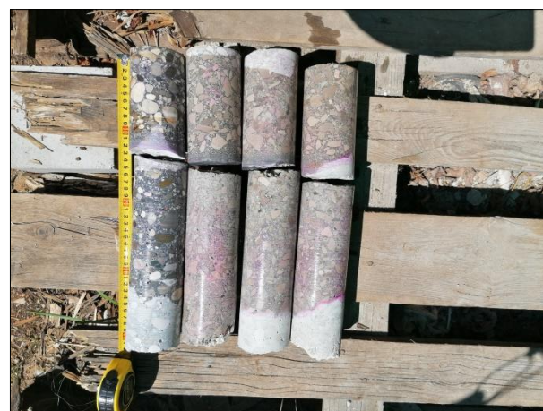
Campioni prelevati C5 C6 C7 C10 e prova di carbonatazione.
