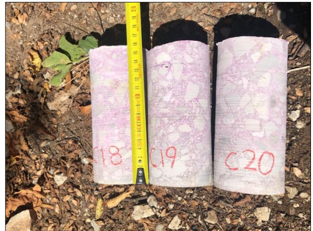
Campioni prelevati C18 C19 C20 e prova di carbonatazione.
