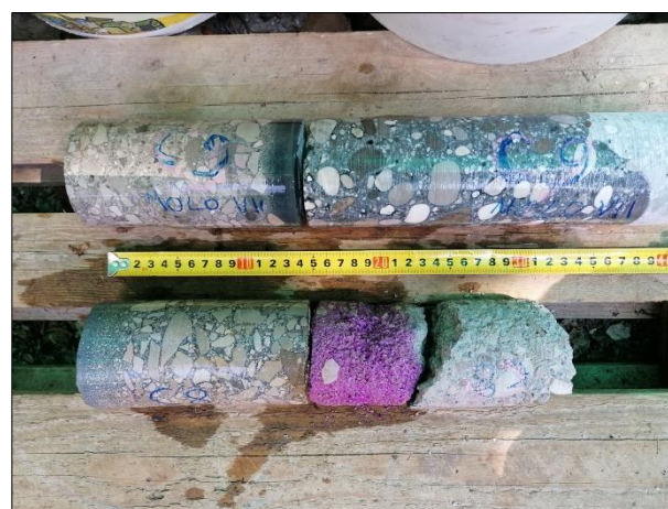
Campioni prelevati C8 e C9 e prova di carbonatazione.
