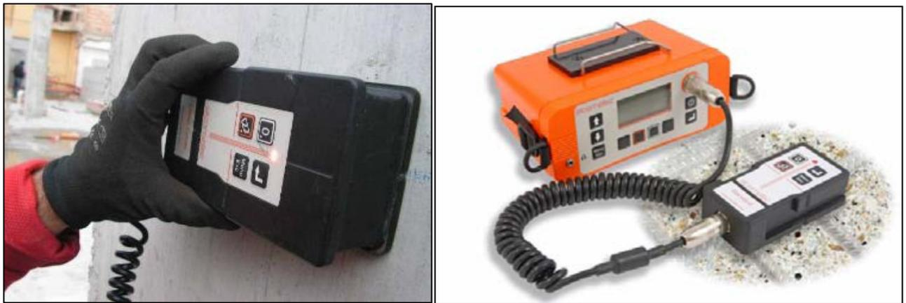
Il rilievo dei ferri d'armatura con il metodo elettromagnetico risulta l'indispensabile ed imprescindibile fase preliminare per qualunque altra tipologia di controllo su strutture in c.a. in quanto evita che la prova venga eseguita a ridosso della carpenteria di una struttura.
