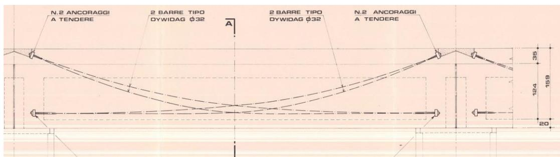
Figura 2.11 – Vista della precompressione integrativa per le travi porta rotaia
