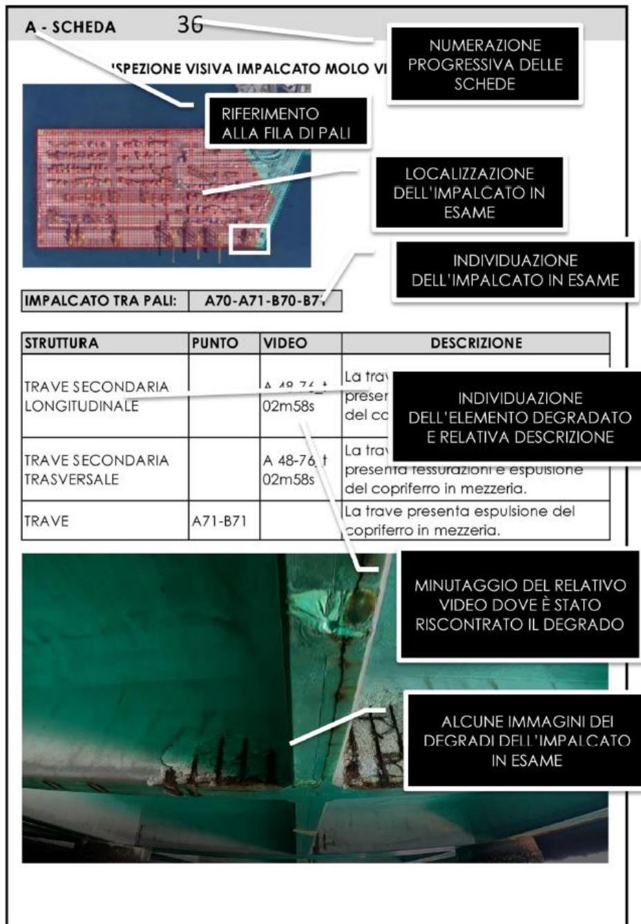
Figura 2.4 – Esempio scheda localizzazione e descrizione degrado.
