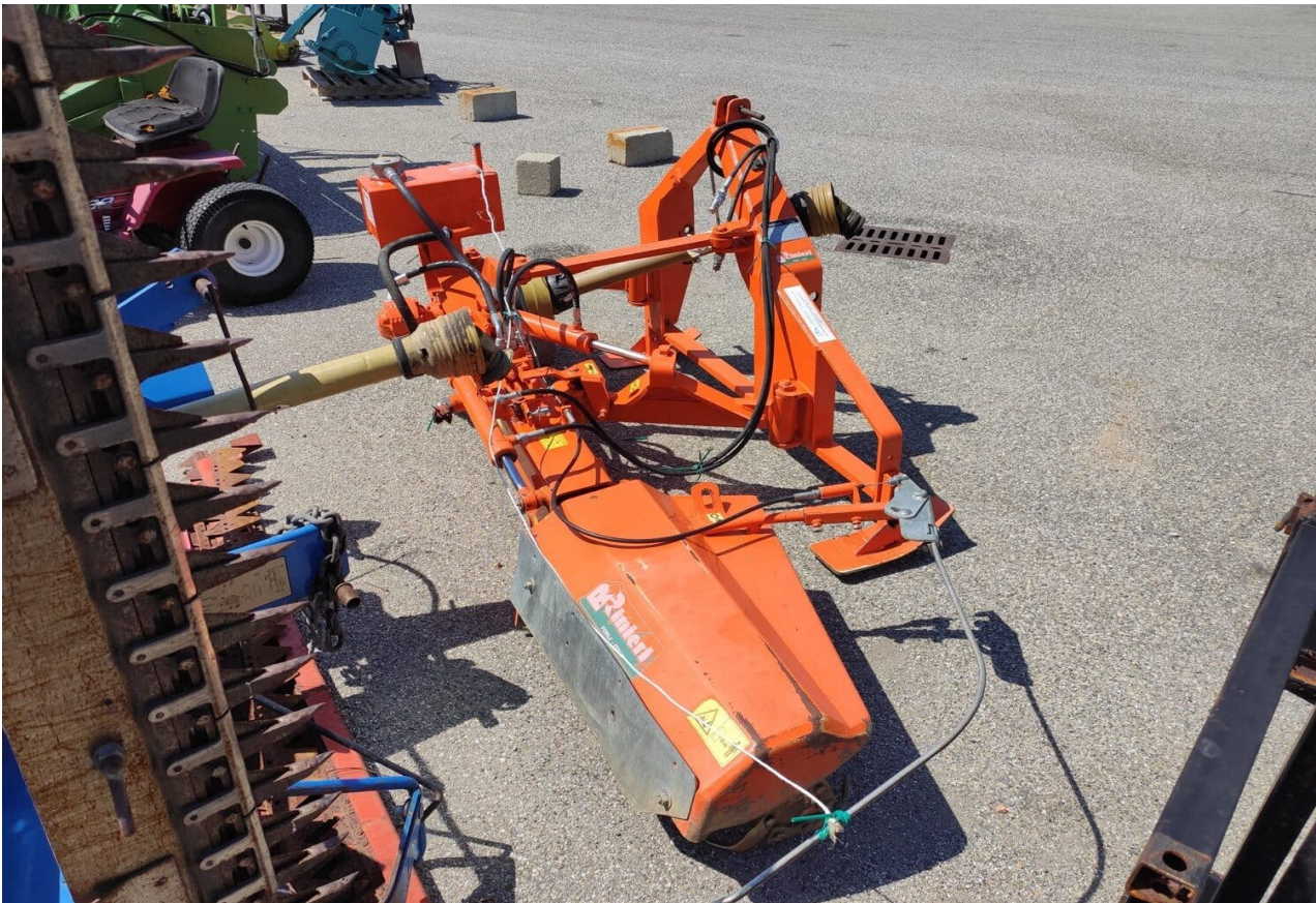
Figura 7 - Fresatrice intercettazione. In primo piano il dispositivo che fa evitare all'attrezzo di urtare i sostegni delle stringhe.
