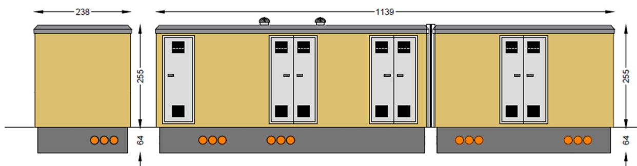
(Prospetto della cabina MTR, misure in cm)
