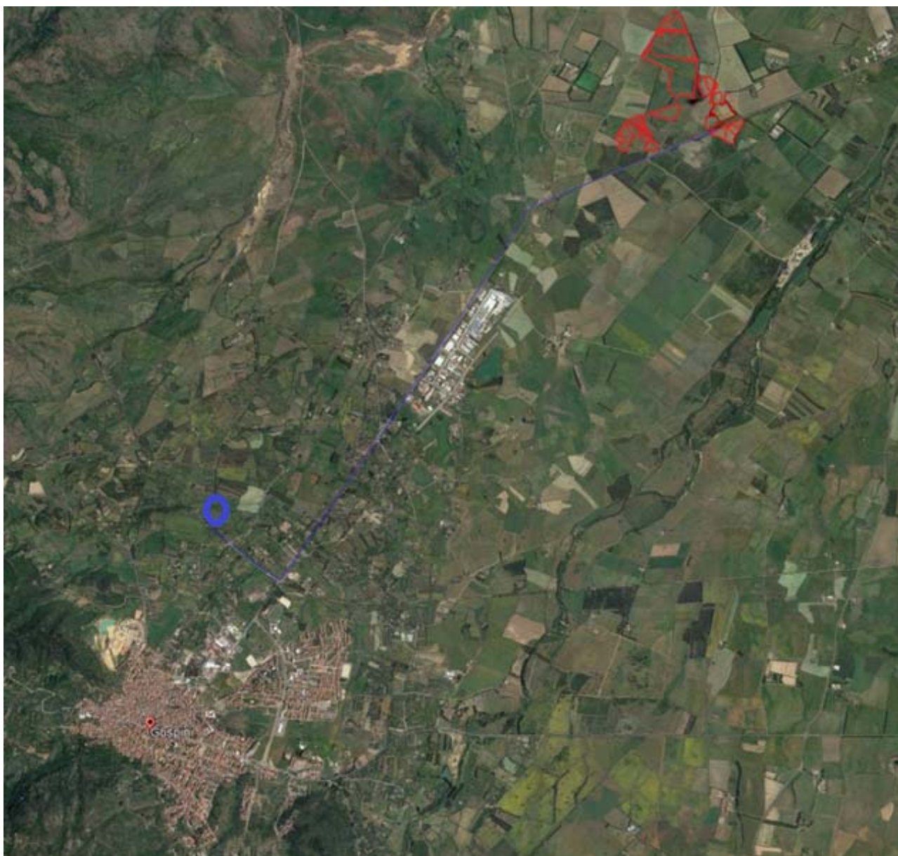
Fig. 2 Inquadramento dell'area rispetto al centro abitato di Guspini (in rosso l'impianto agrivoltaico, in blu l'elettrodotto in AT 36 kV e la cabina di consegna a 36 kV)
