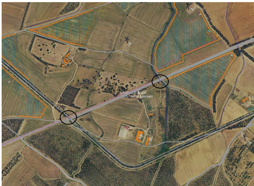
Fig. 5 - punto di attraversamento con tecnologia NO DIG in corrispondenza dei corsi d'acqua
