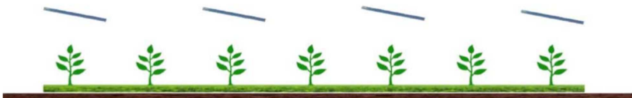
Figura 5 – Rappresentazione schematica di sistema agrivoltaico con coltivazione sia tra le file che al di sotto dei pannelli (Da A. Scognamiglio, ENEA).
