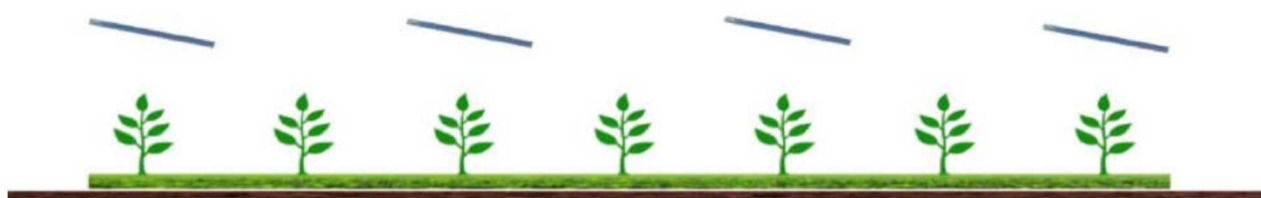
Figura 3 – Rappresentazione schematica di sistema agrivoltaico con coltivazione sia tra le file che al di sotto dei pannelli (Da A. Scognamiglio, ENEA).
