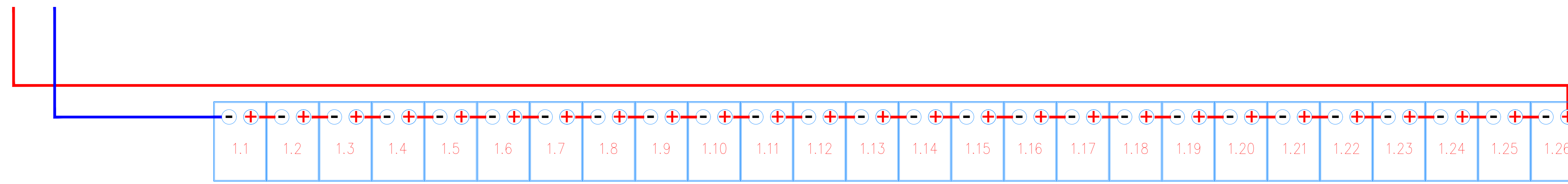
Particolare di cablaggio n° 1 stringa da 26 moduli
